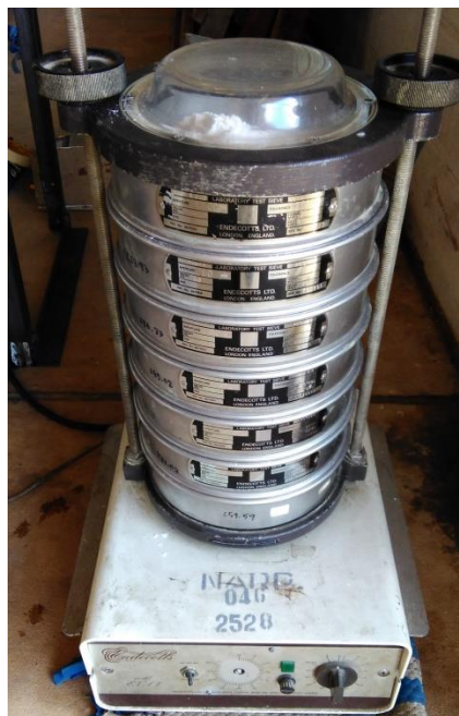
รูปที่ 20 เครื่องคัดขนาดแบบตะแกรงร่อนสำหรับตรวจเช็คเปอร์เซ็นต์แ่งละเอียดและแ่งหยาบ
