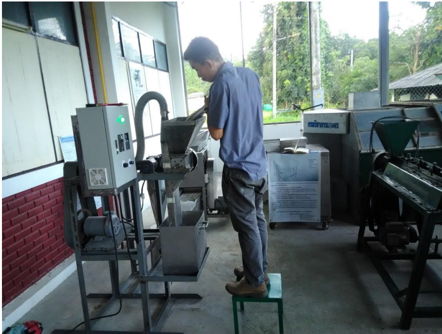
รูปที่ 23 ทดสอบเก็บข้อมูลการใช้งานเครื่องคัขนาดแบ่งโดยใช้ลม ในการคัขนาดแบ่งบัวหลวง
