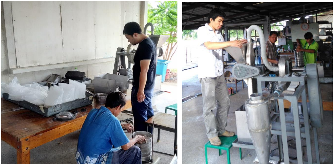
รูปที่ 21 ทดสอบเก็บข้อมูลเครื่องคัดขนาดแป้งโดยใช้ลมในการคัดขนาดแป้งข้าว ที่ศูนย์วิจัยพืชไร่ชัยนาท จ.ชัยนาท
