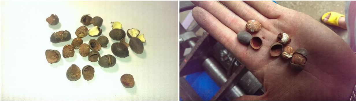
รูปที่ 13 เม็ดบัวแห้งที่ผ่านการกะเทาะมีทั้งเม็ดที่กะเทาะได้สมบูรณ์ เม็ดที่ถูกบีบจนแตกเสียหายและเม็ดที่ไม่ถูกกะเทาะ
