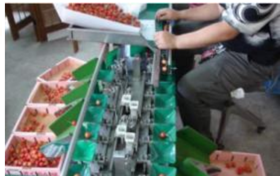
ภาพที่ 2 การคัตน้ำหนักแบบใช้หลักการถ่วงน้ำหนัก
