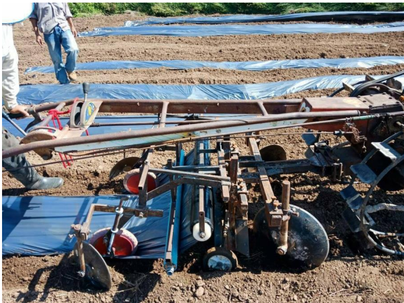
ภาพที่ 7 ต้นแบบเครื่องปูพลาสติกติดรถไถเดินตามสำหรับสตรอเบอร์รี่
