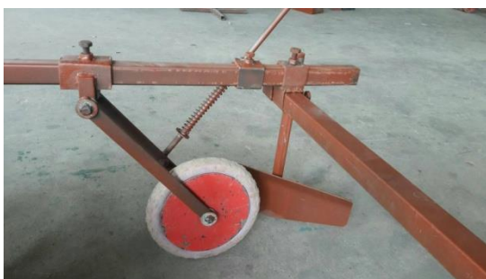
ภาพที่ 11 ชุดขาล้อและใบกลบ ที่ได้รับการปรับปรุงและพัฒนาขึ้นจากต้นแบบเดิม
