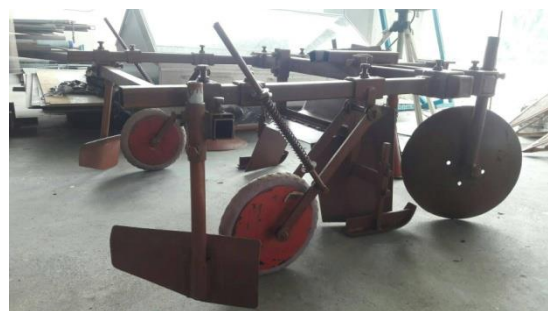
ภาพที่ 11 ชุดขาล้อและใบกลบ ที่ได้รับการปรับปรุงและพัฒนาขึ้นจากต้นแบบเดิม
