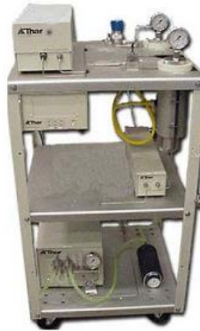
ภาพที่ 2-7 เครื่องสกัดน้ำมันหอมระเหยอัตโนมิติ โดยใช้หลักการสกัดแบบใช้คาร์บอนไดออกไซด์เหลวเหนือจุดวิกฤติ
