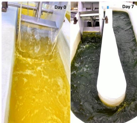
ภาพที่ 8 ลักษณะของการเพาะเลี้ยงสาหร่าย SK-QSGMF6 ในบ่อแบบขยายขนาดแบบเปิดปริมาตร 500 ลิตร
