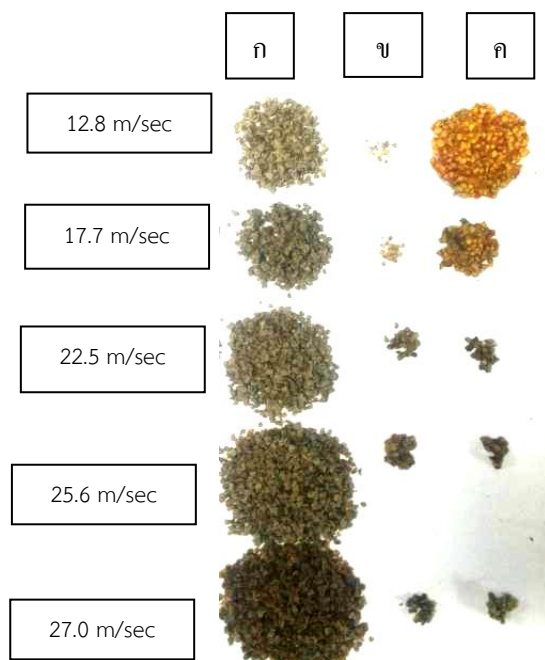
ภาพที่ 43 เปรียบเทียบเมล็ดมะเขือเทศหลังการแยกเนื้อออกที่แต่ละความเร็วของใบตีมะเขือเทศ ก) เมล็ดที่ผ่านตะแกรงและเข้าสู่ช่องรับเมล็ด ข) เมล็ดที่ตกค้างในตะแกรง ค) เมล็ดที่สูญเสียติดไปกับเปลือกที่เข้าสู่ช่องรับเปลือก
