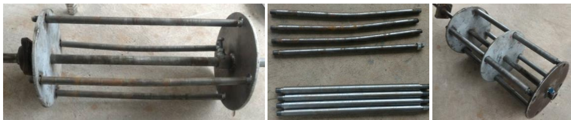
ภาพที่ 27 ก) การโข่งตัวของเพลลาตีแยกเมล็ด ข) เพลลาเดิมและเพลลาใหม่ ค) การประกอบเพลลาใหม่และเหล็กหน้าแปลนยึดเพิ่มความแข็งแรง
