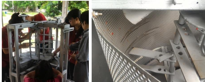
ภาพที่ 26 การโข่งตัวของเพลลา และการฉีดขาดของตะแกรง
