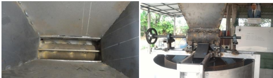
ภาพที่ 22 ชุดป้อนพริกแบบทรงกระบอกติดครีบ แยกช่องป้อนพริกแบบสี่ช่อง
