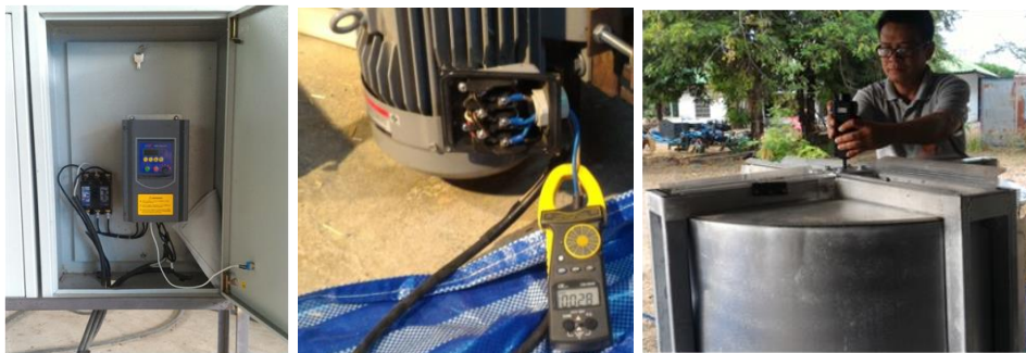
ภาพที่ 19 อุปกรณ์ปรับความเร็วมอเตอร์ขับ เครื่องมือวัดกระแสไฟฟ้า และการใช้อุปกรณ์วัดความเร็วรอบเพล
