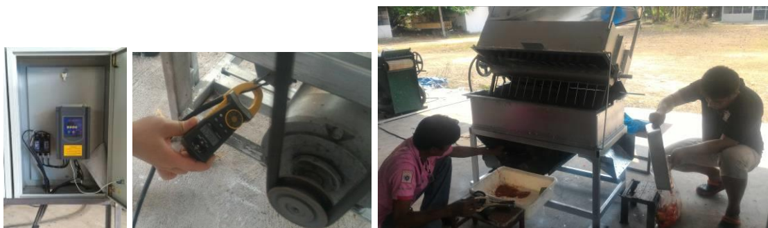
ภาพที่ 40 เครื่องปรับความเร็วรอบมอเตอร์ต้นกำลัง การวัดกระแสไฟฟ้า และการทดสอบการทำงานของเครื่องต้นแบบ
