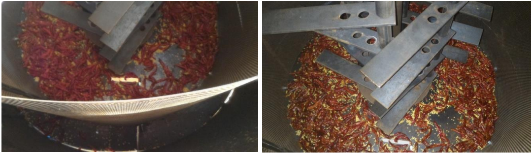
ภาพที่ 21 ผลการแยกเมล็ด การตกค้างของเมล็ด และเปลือกพริกในตะแกรง เมื่อใช้ตะแกรงที่มีขนาดเส้นผ่าศูนย์กลาง 3 มิลลิเมตร และปิดช่องรับเปลือกด้านล่างไว้
