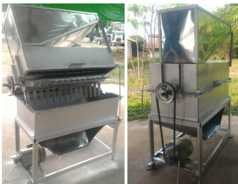
ภาพที่ 39 เครื่องต้นแบบ เครื่องตีแยกเมล็ดมะเขือเทศออกจากเปลือก
