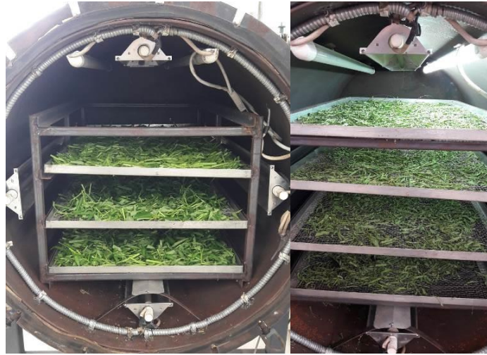
ภาพที่ 16 ทดสอบอบแห้งผักบุ้งเพื่อหาความสัมพันธ์ของความชื้นในห้องอบแห้งกับความชื้นในผลิตภัณฑ์
