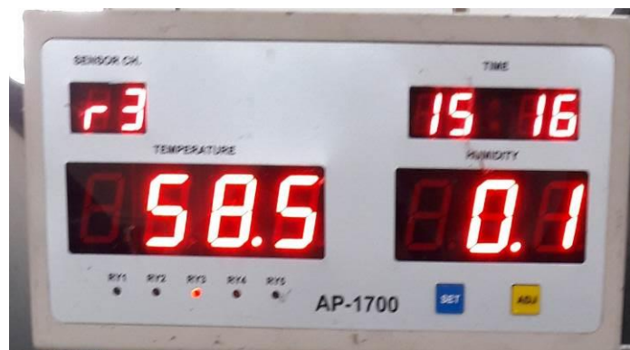
ภาพที่ 15 ความชื้นอากาศในห้องอบแห้งที่ไม่มีผลิตภัณฑ์ เข้าใกล้ศูนย์
