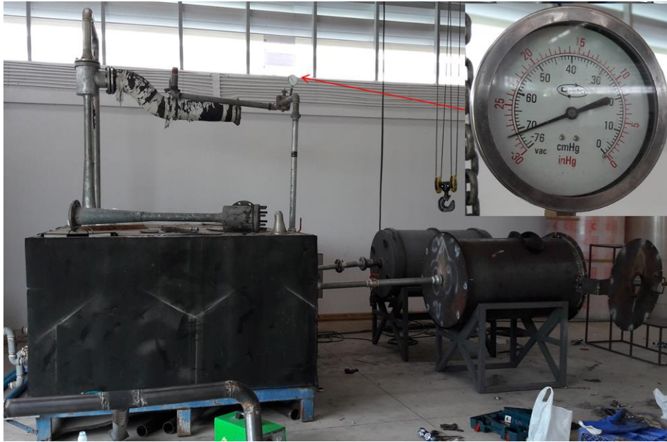
ภาพที่ 14 การประกอบปั๊มลดแรงดันอากาศแบบ water jet กับห้องอบแห้งแบบชั้นวาง
