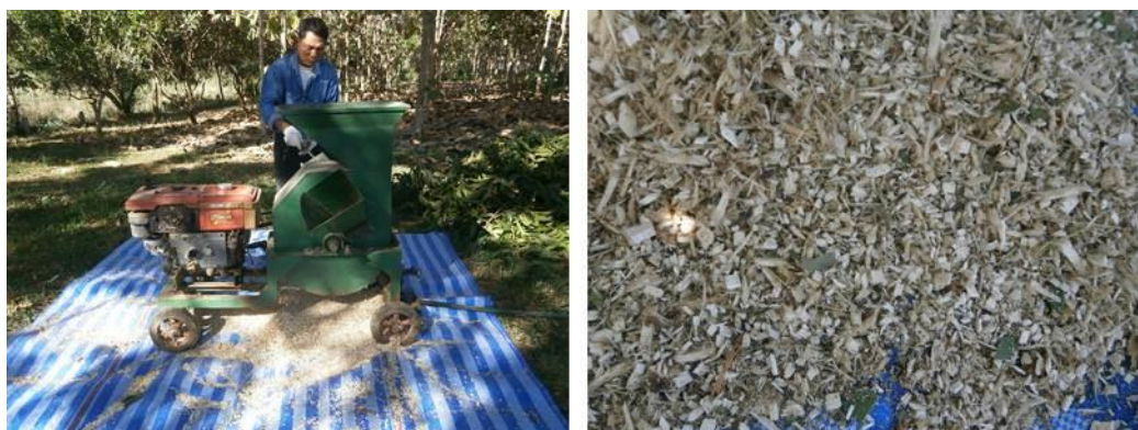
ภาพที่ 4 ทดสอบการหั่นย่อยกิ่งไม้ด้วยเครื่องหั่นย่อยซากกิ่งไม้ผล
