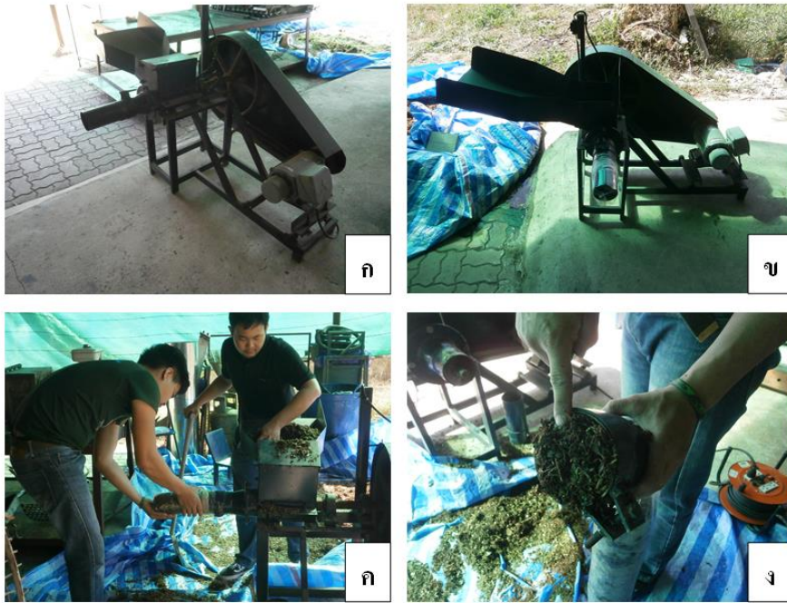
ภาพที่ 6 ก.เครื่องอัดวัสดุเพาะเห็ดจากเศษเปลือกฝักข้าวโพดแบบก้อนยาว (เกรียงศักดิ์, 2561) ข.การใส่ถุงเพาะเห็ด ค.การป้อนวัสดุเพาะเห็ดและการประคองก้อนเพาะเห็ด และ ง.วัสดุเพาะเห็ดอัดติดแน่นตรงปลายท่อ
