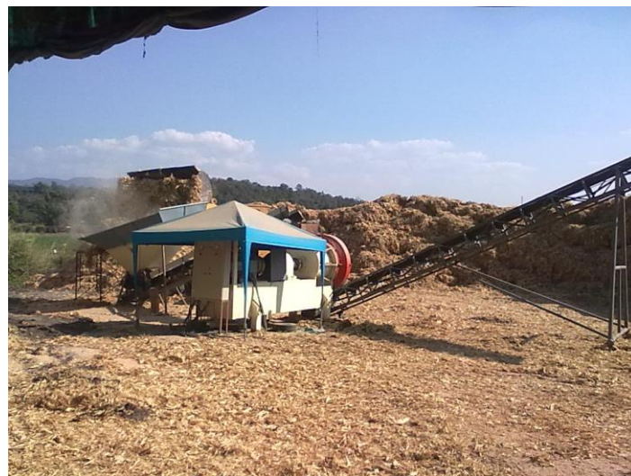
ภาพที่ 5 การทดสอบเครื่องอัดเชื้อเพลิงชีวมวลแบบแท่งเหลี่ยมกำจัดเปลือกและซังข้าวโพดเลี้ยงสัตว์ที่จังหวัดเชียงราย
