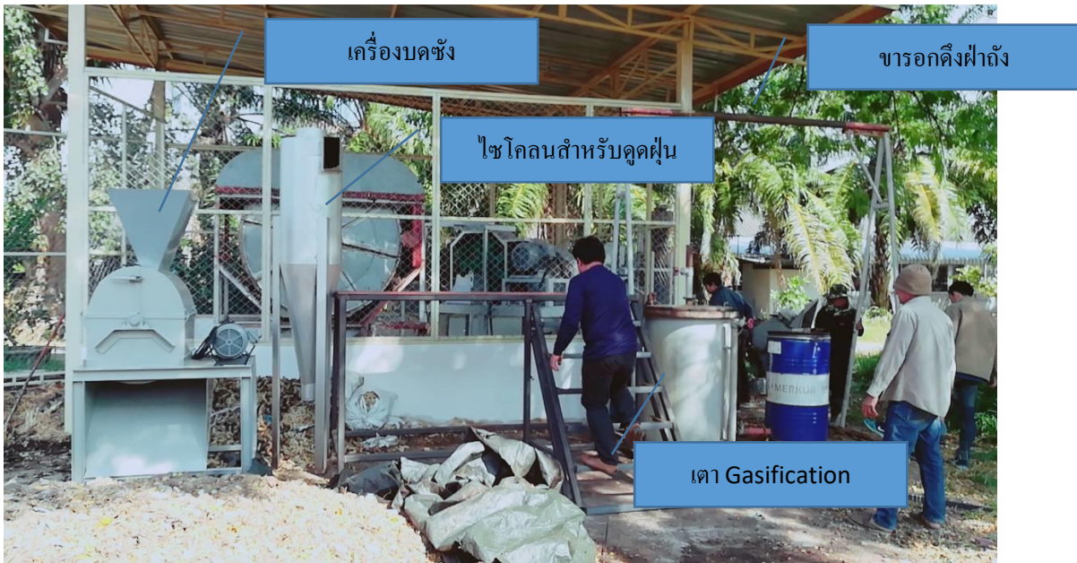
ภาพที่ 9 การสร้างโรงงานต้นแบบเพื่อแปรรูปเปลือกและซังสำหรับการเป็นเชื้อเพลิง
