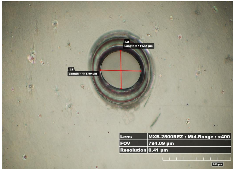
ภาพที่ 1 ลักษณะและขนาดเส้นผ่าศูนย์กลางของรูเจาะของฟิล์ม OPP ความหนา 30 ไมครอน เมื่อเจาะรูโดยใช้ความเร็วสแกน 1,000 มิลลิเมตร/วินาที กำลังเลเซอร์ 20 เปอร์เซ็นต์
