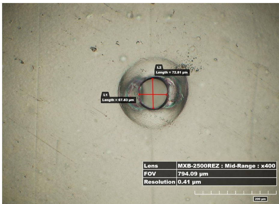
ภาพที่ 2 ลักษณะและขนาดเส้นผ่าศูนย์กลางของรูเจาะของฟิล์ม LDPE ความหนา 30 ไมครอน เมื่อเจาะรูโดยใช้ความเร็วสแกน 500 มิลลิเมตร/วินาที กำลังเลเซอร์ 30 เปอร์เซ็นต์
