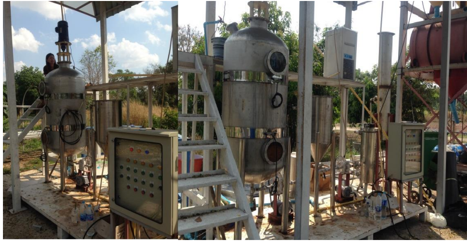
ภาพที่ 3 ถังหมักและเครื่องกลั่นต้นแบบของกรมวิชาการเกษตรเพื่อใช้ในกระบวนการผลิตไบโอเอทานอล
