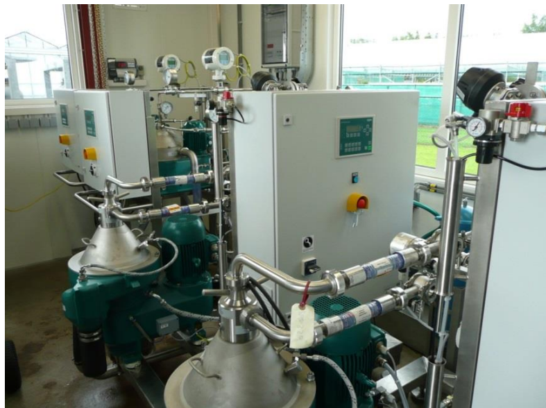
ภาพที่ 2 เครื่องเหวี่ยงแยกความเร็วสูงแบบต่อเนื่อง นำเข้าจากต่างประเทศ ที่มา : บริษัทจีอีเอสเฟาเลียเซฟพาทเรเตอร์ (ประเทศไทย) จำกัด
