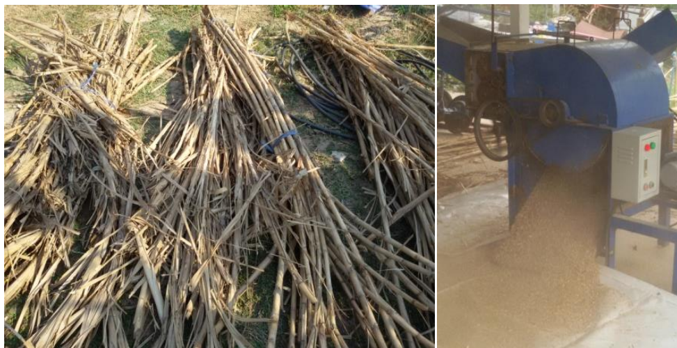
ภาพที่ 5 การทดสอบหั่นย่อยและเตรียมวัสดุชีวมวลสำหรับการบดละเอียด
