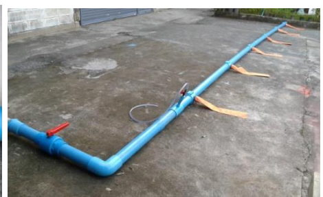
(ค) ท่อจ่ายน้ำตามร่องที่สวมท่ออ่อนป้องกันการกัดเซาะดิน
