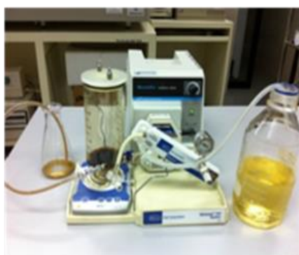
ภาพที่ 3 วิธีการกรองด้วยเครื่อง Tangential Flow Filtration (TFF) โดยผ่าน membrane ขนาด 10K และ เอนไซม์รูปแบบผงแห้งที่ผ่านวิธีการ freeze drying method
