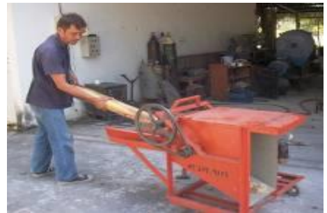
ทดสอบหั่นย่อยด้วยเครื่องหั่นย่อยต้นกล้วย
