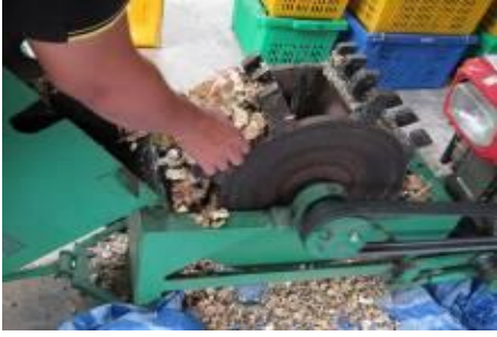
ลักษณะของเปลือกทุเรียนและเส้นใยต้นกล้วยที่ติดอยู่ที่เครื่องหั่นย่อยกิ่งไม้
