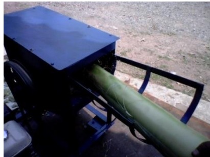
เครื่องหันย่อยต้นกล้วย หลังการปรับปรุง
