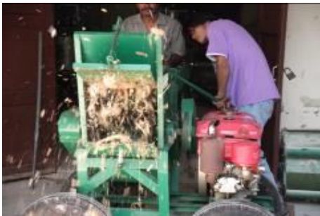
ทดสอบหั่นย่อยต้นกล้วยด้วยเครื่องหั่นทางปาล์มน้ำมัน
