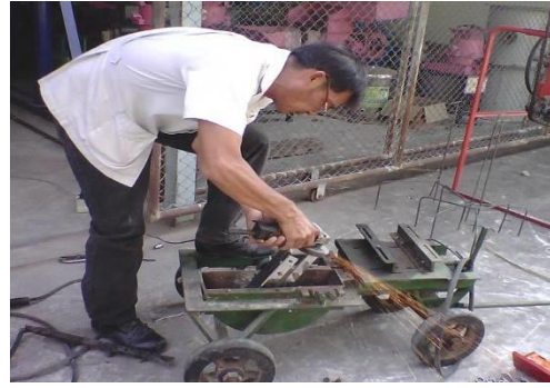
การออกแบบและแก้ไขต้นแบบ เครื่องหั่นย่อยสำหรับเปลือกทุเรียน
