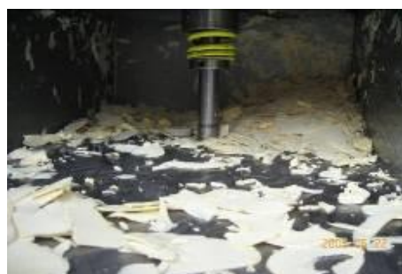
มีชิ้นเนื้อทุเรียนที่ฟานได้ติดที่ตัวเครื่องจำนวนมาก
