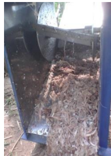
เครื่องหันย่อยต้นกล้วย หลังการปรับปรุง
