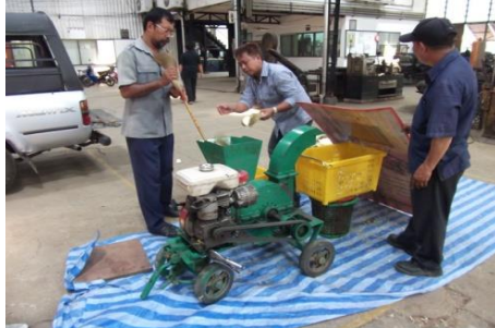
ทดสอบเครื่องหั่นย่อยพืชเส้นใย
