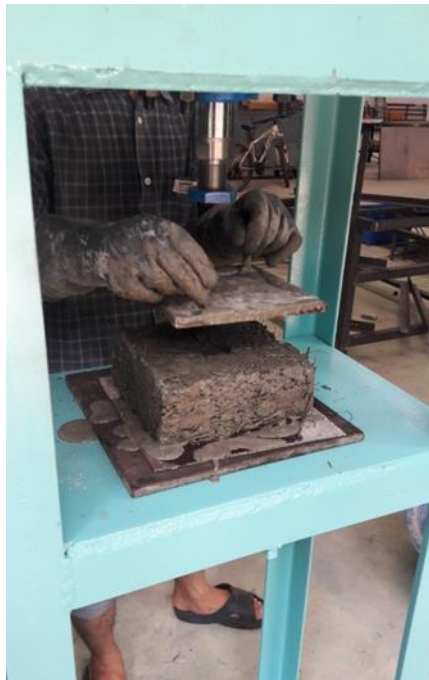
ภาพที่ 2.9 การอัดขึ้นรูปก้อนวัสดุปลูกจาก เปลือก ต้น และซังข้าวโพด
