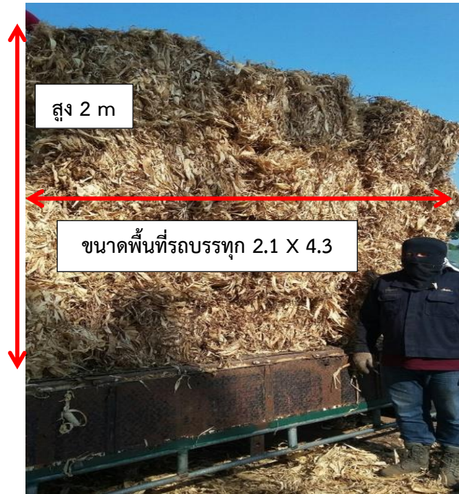
ภาพที่ 3.35 การจัดเรียงก้อนชีวมวลสำหรับขนส่ง 1 ครั้ง สำหรับรถบรรทุกที่มี (รถบรรทุก 6 ล้อขนาดกลาง) สามารถบรรทุกชีวมวลได้เต็มอัตราจำนวน 68 ก้อน
