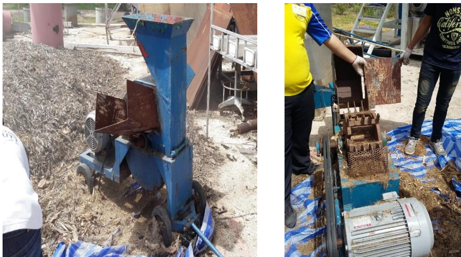
ภาพที่ 1.8 การทดสอบเครื่องสับย่อย (Hammer mill) แบบใบอยู่กับที่ของสถาบันวิจัยเกษตร
