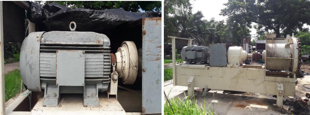
ภาพที่ 3.2 ต้นกำลังเครื่องอัดก้อนชีวมวลจากโรงงานเอกชนมาเพื่อศึกษาและพัฒนาแบบจำลองการบริหารจัดการชีวมวลที่เกิดจากการผลิตข้าวโพดเลี้ยงสัตว์ที่ศูนย์วิจัยเกษตรวิศวกรรมขอนแก่น
