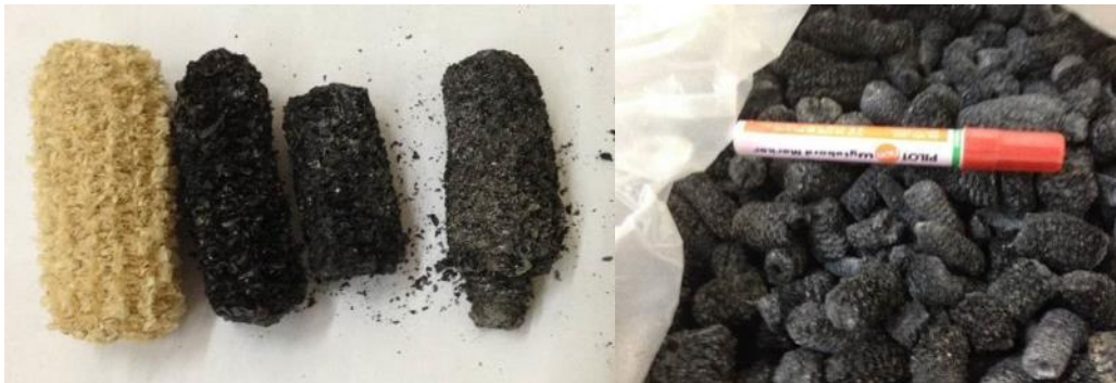
ภาพที่ 2.7 ลักษณะ Biocharcoal จากซังข้าวโพดที่เผาได้เพื่อนำไปเป็นวัสดุปลูกกล้วยไม้
