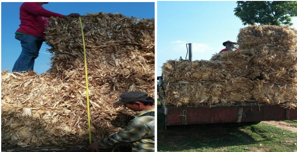
ภาพที่ 3.34 รถบรรจุทุกที่ทำการขนส่งชีวมวลมีความกว้าง 2.10 เมตรยาว 4.30 เมตร ระยะความสูงในการบรรจุทุกก้อนชีวมวลอยู่ที่ 2 เมตร จัดเรียงได้ 3 แถว จำนวนแถวละ 4 ก้อน สำหรับแถวด้านข้าง และ 3 ก้อนสำหรับแถวกลาง
