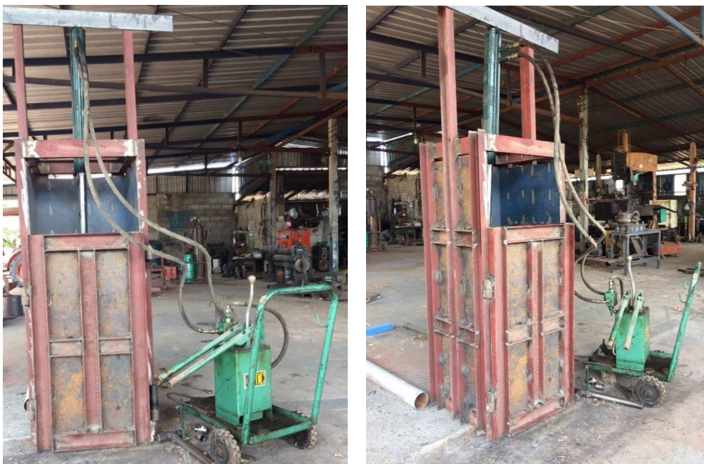
ภาพที่ 3.8 เครื่องต้นแบบเครื่องอัดเปลือกข้าวโพดแนวตั้ง
