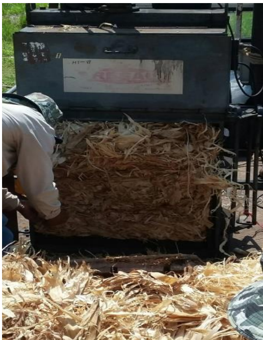
ภาพที่ 3.14 การทดสอบอัดก้อนเปลือกและซังข้าวโพดโดยใช้เครื่องอัดก้อนชีวมวลที่นำเข้ามาจากต่างประเทศ
