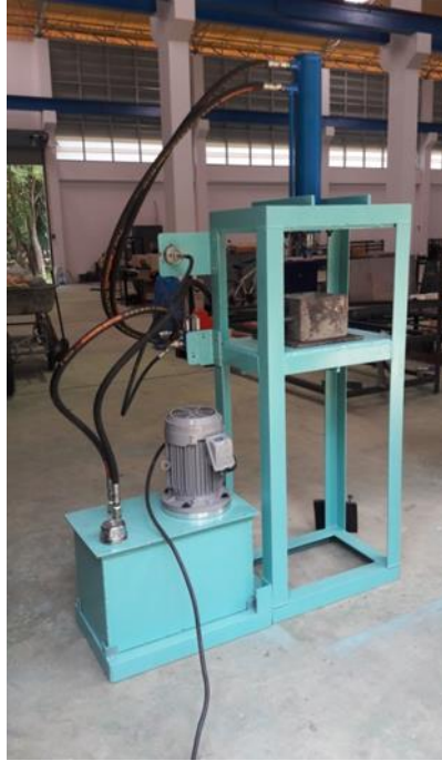
ภาพที่ 2.8 การทดสอบผลิตก้อนวัสดุปลูกด้วยเครื่องต้นแบบ
