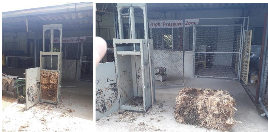
ภาพที่ 3.8 เครื่องต้นแบบเครื่องอัดเปลือกข้าวโพดแนวตั้ง
