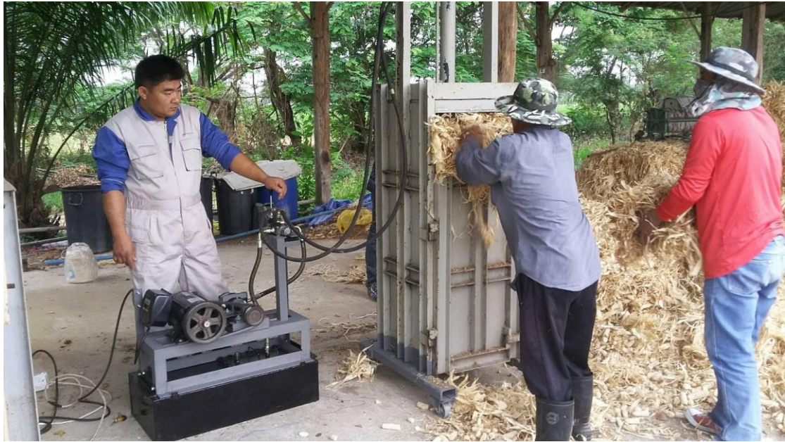
ภาพที่ 3.11 การพัฒนาไส้ตันกำลังมอเตอร์ต้นกำลัง 2 แรงม้า 1 เฟส บีบเฟือง 10 cc/rev วาล์ว 4/3 ซึ่งจากการทดสอบเบื้องต้นเวลาต่อก่อน 5 นาที 40 วินาที ในสภาวะเปลือกข้าวโพดแห้งมาก
