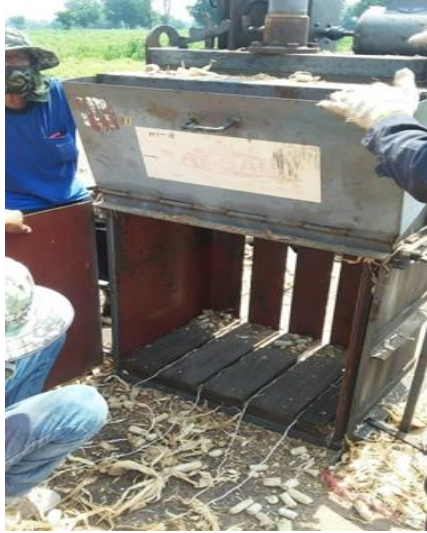
ภาพที่ 3.15 นำซีวมวลออกจากเครื่องอัดก้อนและทำการชั่งน้ำหนัก โดยบันทึกระยะเวลาการอัดก้อน ตั้งแต่เริ่มกระบวนการของการอัดซีวมวล 1 ก้อน
