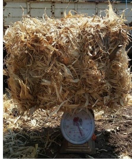
ภาพที่ 3.15 นำซีวมวลออกจากเครื่องอัดก้อนและทำการชั่งน้ำหนัก โดยบันทึกระยะเวลาการอัดก้อน ตั้งแต่เริ่มกระบวนการของการอัดซีวมวล 1 ก้อน
