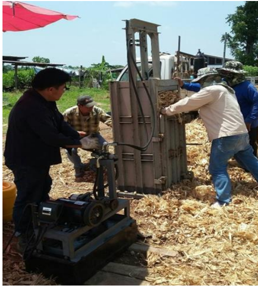
ภาพที่ 3.12 การทำงานของเครื่องอัดชีวมวลแบบไฮดรอลิกที่มีการพัฒนาขึ้น
