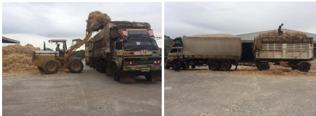
ภาพที่ 3.28 การขนย้ายเปลือกและซังข้าวโพดจากลานตากขึ้นบรรทุกบนรถพ่วงด้วยรถตัก (komatsu)
