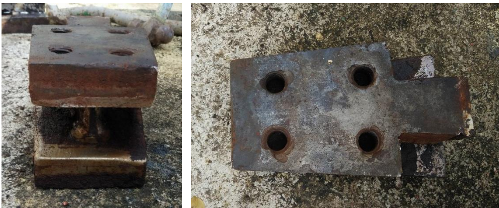
ภาพที่ 3.6 ลักษณะหัวอัดที่นำไปพัฒนาโดยใช้เหล็กหล่อเหนียวและปรับองค์ประกอบทางเคมีของเนื้อวัสดุ
