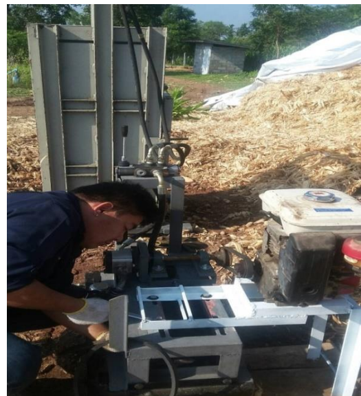
ภาพที่ 3.13 การทดสอบเครื่องอัดชีวมวลแบบไฮดรอลิกที่มีการพัฒนาขึ้นกับต้นกำลังเครื่องยนต์เบนซินขนาด 5.5 แรง
