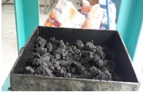
ภาพที่ 2.10 การอัดขึ้นรูปก้อนวัสดุปลูกจากถ่านซังข้าวโพด
