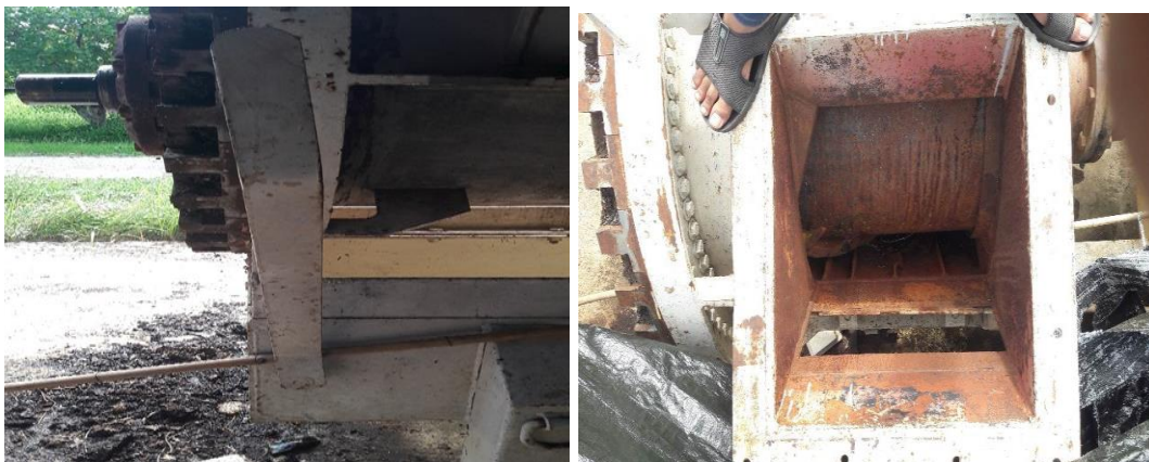
ภาพที่ 3.3 มีคั่นโยกคลัชเพื่อทำให้การตัดกำลังการหมุนจากมอเตอร์มายังเครื่องอัดและมีแม่เหล็กเพื่อป้องกันเศษวัสดุอื่นๆที่ไม่ประสงค์ลงไปเช่น โลหะ ซึ่งจะส่งต่อความเสียหายต่อเครื่องอัด
