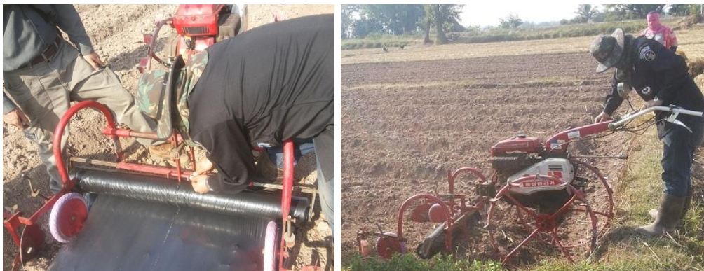
ภาพที่ 8 การปูและกลบพลาสติกด้วยเครื่องตีฟุ้งท้ายเครื่องยนต์เบนซิน (สนอง อมฤกษ์, อีรศักดิ์ โกเมฆ ,2557)
