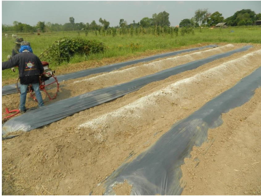
ภาพที่ 9 การปูและกลบพลาสติกด้วยเครื่องติดท้ายเครื่องยนต์เบนซิน ที่สามารถทำงานในที่แคบ และการกลบดินที่สนิทกว่าใช้แรงคน(สนอง อมฤกษ์, ธีรศักดิ์ โกเมฆ ,2557)
