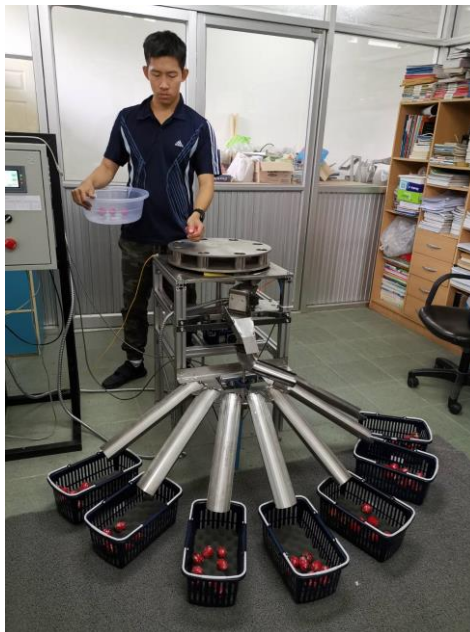
ภาพที่ 33 ทดสอบเครื่องต้นแบบเพื่อการคัดแยกขนาดผลโดยน้ำหนัก 7 เกรด
