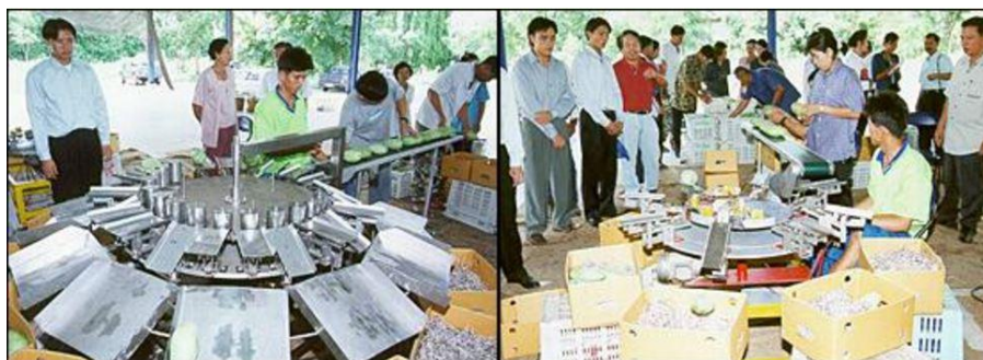
ภาพที่ 5 เครื่องคัดมะม่วงโดยใช้น้ำหนักเป็นเกณฑ์ (กล้าณรงค์ และคณะ, 2545)
