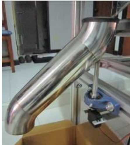
ภาพที่ 16 ท่อจ่ายคัดแยกขนาดผลโดยน้ำหนัก
