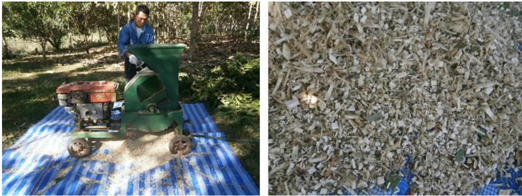
ภาพที่ 4 ทดสอบการหั่นย่อยกิ่งไม้ด้วยเครื่องหั่นย่อยซากกิ่งไม้ผล
