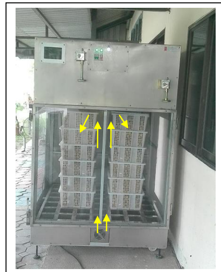
ภาพที่ 1 การรมโอโซนด้วยเครื่องกำลังการผลิต 30 กรัม/ชม. หลังรม SO 2 เข้มข้น 1.5% โดยรม 3-4 ตะกร้าต่อครั้ง ห้องรมขนาดเล็กมีขนาดกว้าง x ยาว x สูง = 0.90x0.60x0.80 เมตร คิดเป็นปริมาตรเท่ากับ 0.432 ลบ.ม. ทำจากอะคริลิกใสหนา 5 มม. โครงเหล็กขอบประตูมียางกันแก๊สรั่ว มีจุดเชื่อมเป็นท่อพีวีซีเป็นท่อนำแก๊สโอโซนและมีท่อกระจายแก๊สอยู่บริเวณใต้พื้นตะกร้า 2 จุด (→)
