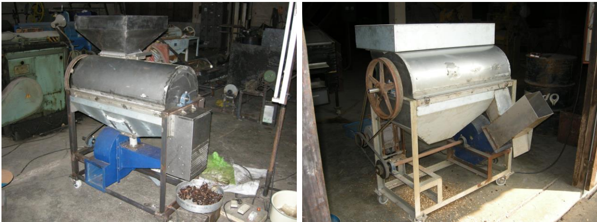
รูปที่ 7 เครื่องกะเทาะเปลือกต้นแบบที่ 1 ก่อนแก้ไข (ซ้าย) และหลังแก้ไขส่วนพัตลมแยกเปลือก (ขวา)
