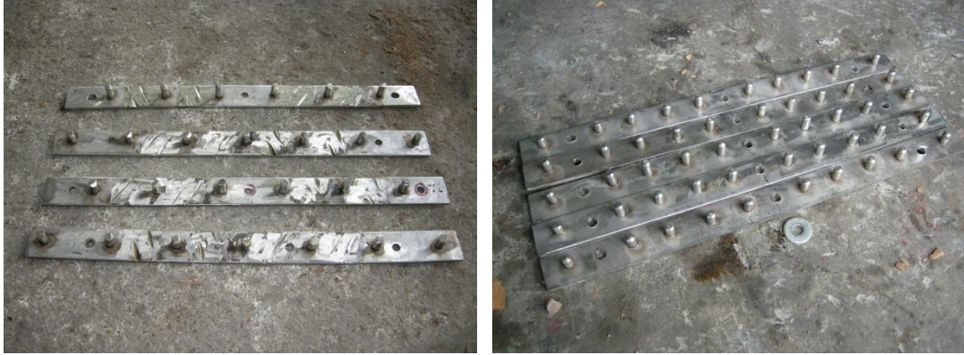
รูปที่ 9 ลักษณะก้านปะทะแบบ 4 แถว (ซ้าย) และ แบบ 5 แถว (ขวา)
