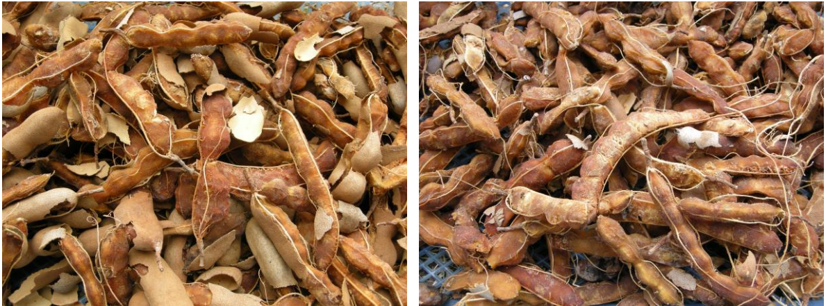
รูปที่ 10 ลักษณะเนื้อมะขามจากการกะเทาะเปลือกด้วยเครื่องต้นแบบที่ 2 รอบที่ 1 (ซ้าย) และ รอบที่ 2 (ขวา)
