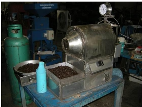
รูปที่ 1 เครื่องคั่วเม็ดมะขาม ประกอบด้วย ถังคั่วรูปทรงกระบอก อุปกรณ์ให้ความร้อนและพัดลมดูดควัน
