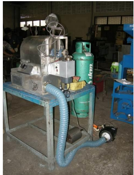
รูปที่ 1 เครื่องคั่วเม็ดมะขาม ประกอบด้วย ถังคั่วรูปทรงกระบอก อุปกรณ์ให้ความร้อนและพัดลมดูดควัน
