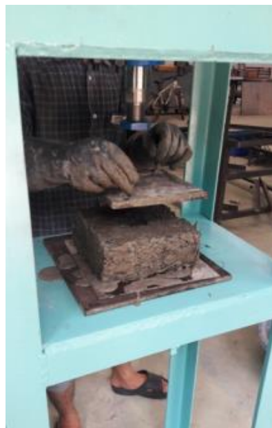
รูปที่ 11 การอัดขึ้นรูปก้อนวัสดุปลูกจาก เปลือก ต้น และซังข้าวโพด
