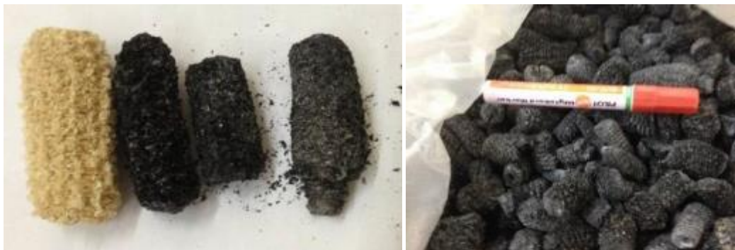
รูปที่ 9 ลักษณะ Biocharcoal จากซังข้าวโพดที่เผาได้เพื่อนำไปเป็นวัสดุปลูกกล้วยไม้
