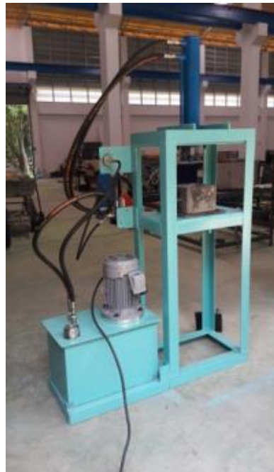
รูปที่ 10 การทดสอบผลิตก้อนวัสดุปลูกด้วยเครื่องต้นแบบ
