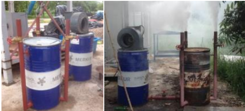
รูปที่ 8 เตาเผา Biocharcoal จากเปลือกและซังข้าวโพดและการไล่ความชื้น
