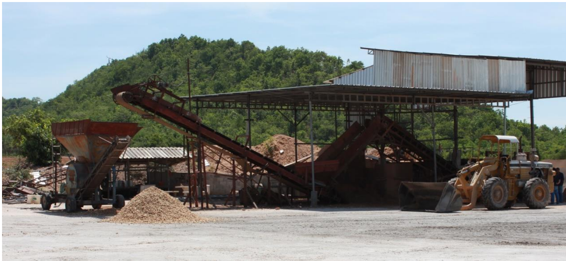
รูปที่ 5 เครื่องทำความสะอาดหัวมันสำปะหลังแบบสายพานและตะแกรงร่อน (1 ตะแกรง)
