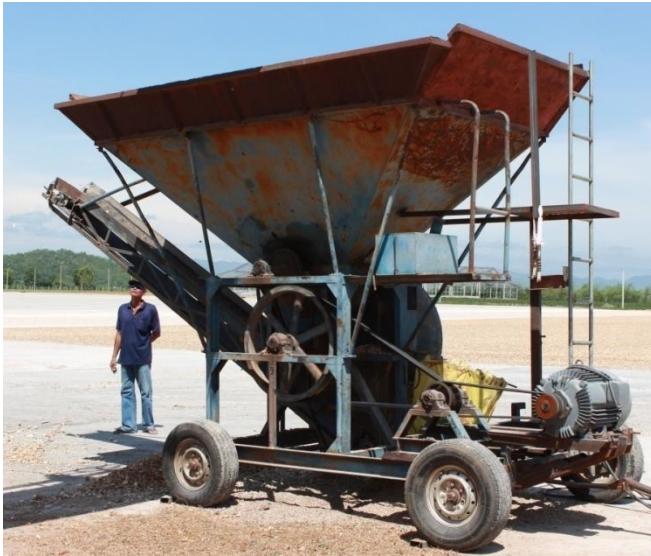
รูปที่ 9 เครื่องสับมันเส้น ใบสับเป็นแบบจานหมุน
