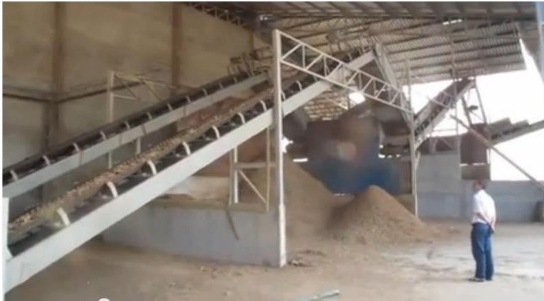
รูปที่ 6 เครื่องทำความสะอาดหัวมันสำปะหลังแบบสายพานและตะแกรงร่อน (2 ตะแกรง) เพิ่มความสามารถในการทำงานโดยการเพิ่มจำนวนชุด
