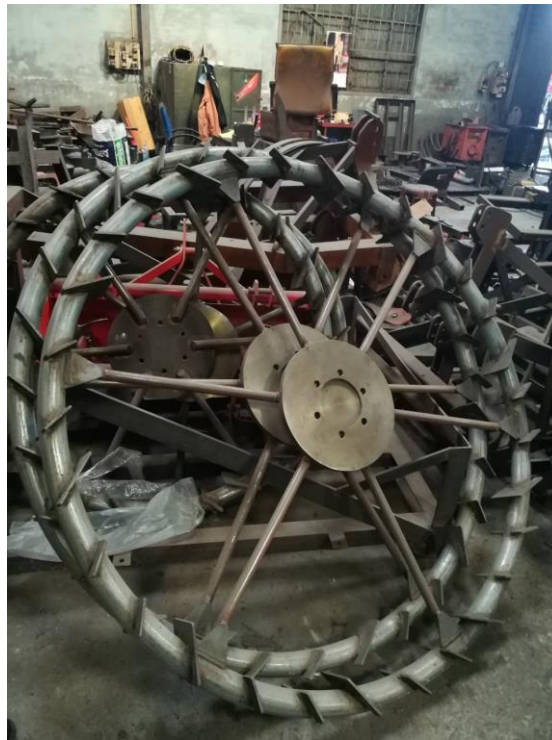
รูปที่ 24 ล้อเหล็กสูงสำหรับรถแทรกเตอร์
