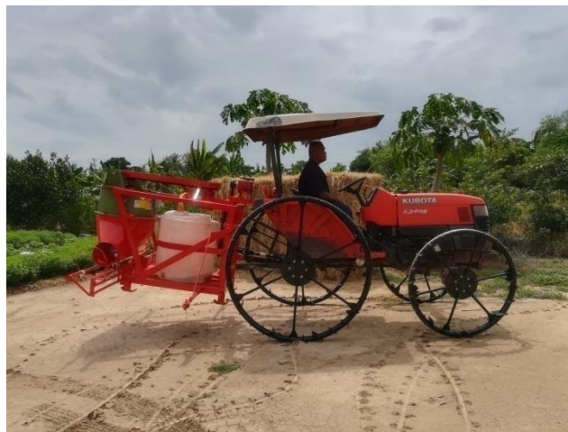
รูปที่ 26 รถแทรกเตอร์ต้นแบบเมื่อติดตั้งเครื่องพ่นแบบอู่มองค์ลม
