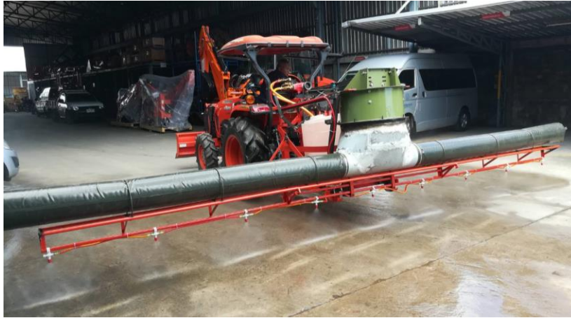
รูปที่ 21 เครื่องพ่นแบบอุโมงค์ลมเมื่อปรับตำแหน่งหัวฉีด
