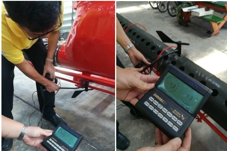
รูปที่ 22 การวัดอัตราการลมที่ช่องทางออกของอุโมงค์ลม
