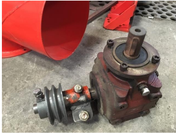
รูปที่ 9 หัวเกียร์ทดสำหรับสร้างต้นแบบที่ 2
