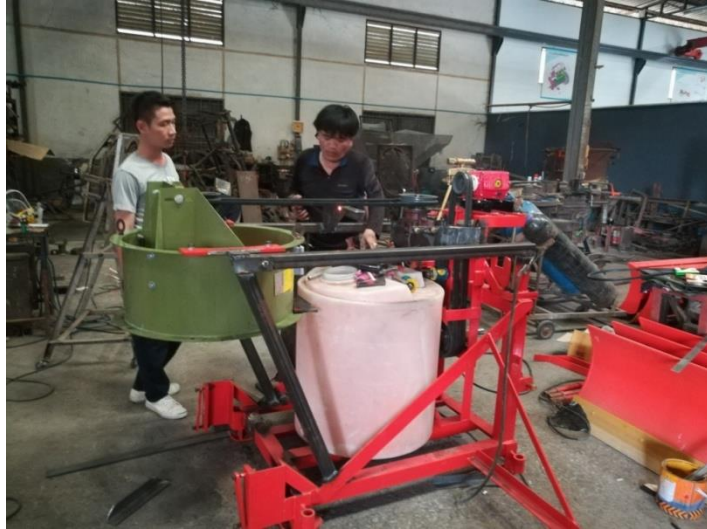
รูปที่ 12 ชุดขับเคลื่อนต้นแบบเมื่อประกอบกับพัดลม
