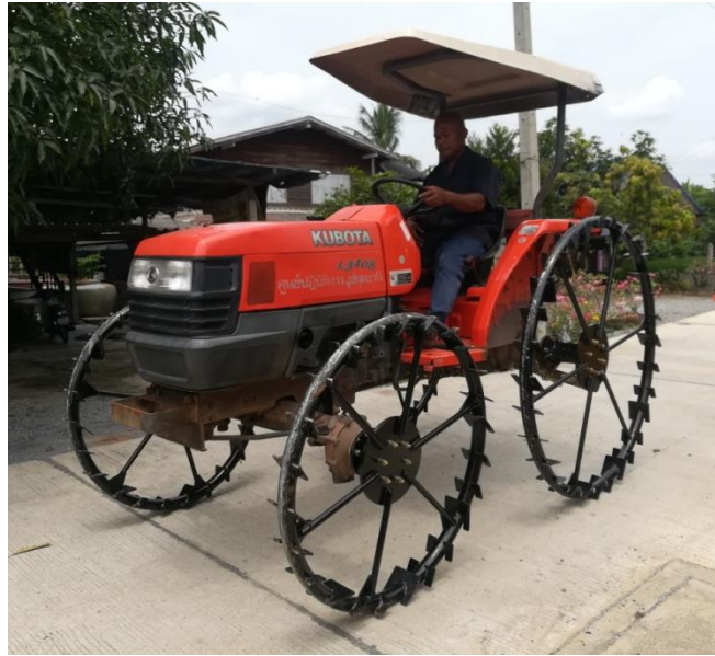
รูปที่ 25 รถแทรกเตอร์ล้อเหล็กที่ใช้เป็นต้นแบบ
