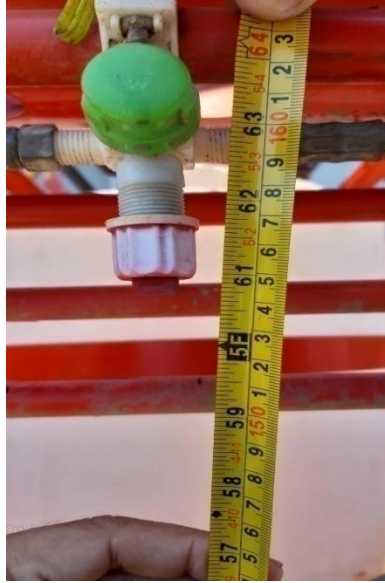
รูปที่ 50 ความสูงหัวฉีดจากพื้นดิน 160 เซนติเมตร
