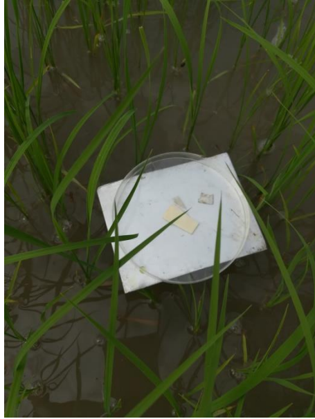
รูปที่ 40 ติดแผ่น plate เส้นผ่าศูนย์กลาง 10 เซนติเมตร ที่ระดับผิวน้ำ เพื่อตรวจดูการสูญเสียน้ำของละอองลงสู่ดิน
