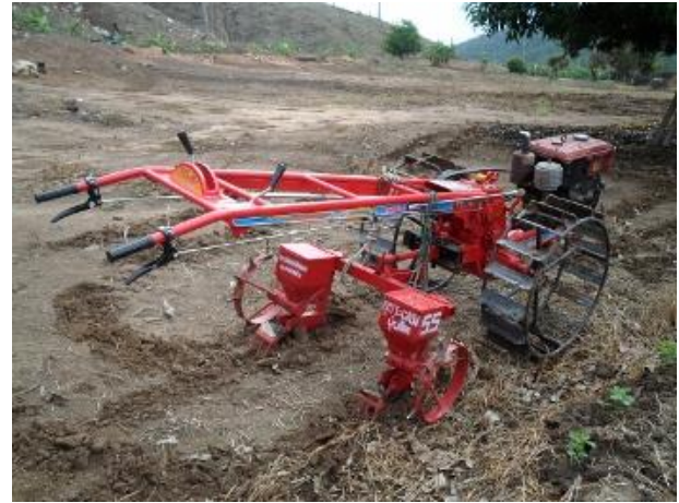
ภาพที่ 12 เครื่องหยอดเมล็ดติดกับรถไถนา
