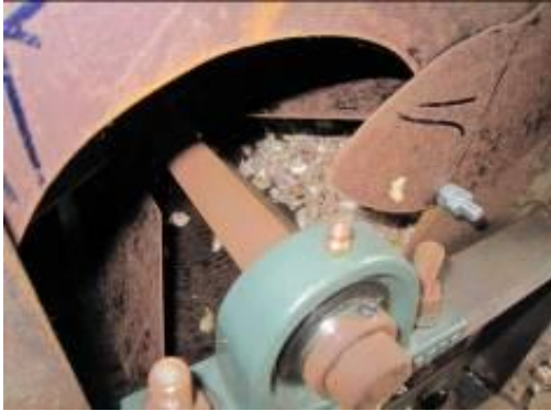
ภาพที่ 8.5-3 แก๊ไขปรับปรุงแผ่นปิดบังคับ ลมเข้าของชุดพัดลมทำความสะอาด
