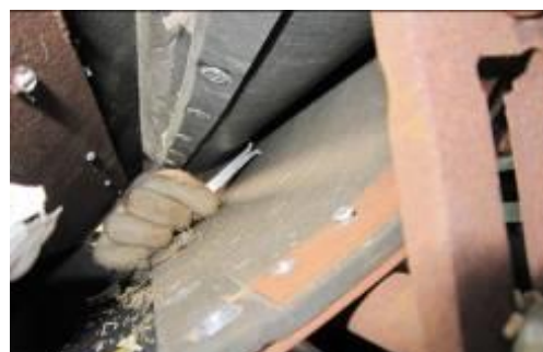
ภาพที่ 8.5-2 แก้ไขปรับปรุงลูกยางกะเทาะตัวล่างและแผ่นตั้งระยะปาก
