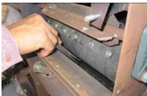
ภาพที่ 8.5-1 แก้ไขปรับปรุงลูกยางกะเทาะตัวบนและแผ่นตั้งระยะปาก
