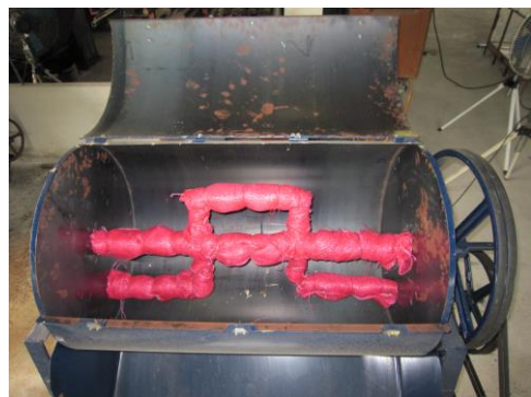
ภาพที่ 8.6-2 แสดงแกนใบกวนที่หุ้มด้วย วัสดุพลาสติกเส้นสานเหนียวกันกระแตก
