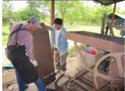
ภาพที่ 8.5-4 แก๊ไขปรับปรุงปล่องลมออก ของชุดพัดลมทำความสะอาด
