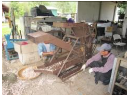
ภาพที่ 8.4-6 แสดงตะแกรงโยกทำความสะอาดใช้เพลลาเยื้องศูนย์
