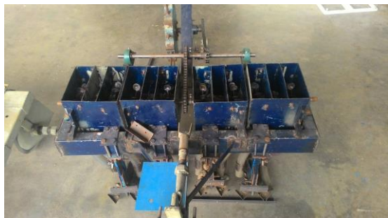
ภาพที่ 8.6-1 การเปรียบเทียบเครื่องหยอดกระเทียมแบบกะพ้อตักชนิด 8 แถว และชนิด 6 แถว
