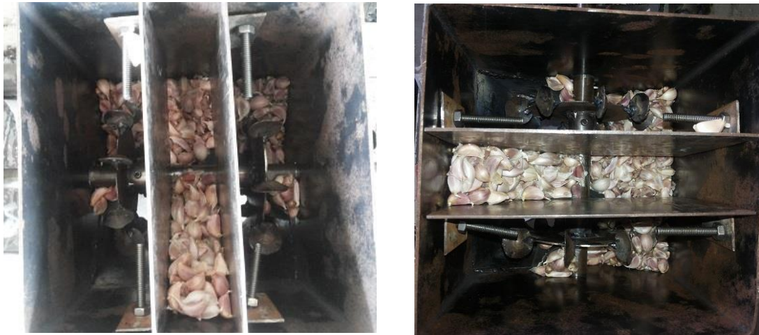
ภาพที่ 8.5-5 การปรับปรุงเครื่องหยอดแบบกระพ้อดัก ให้มีส่วนห้องเก็บกระเทียม ห้องป้อน และห้องดักกระเทียม เพื่อความแม่นยำยิ่งขึ้น
