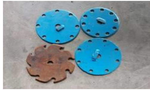
ภาพที่ 8.4-1 การเลือกงานหยอดและปลอกลูกหยอดที่มีขนาดเหมาะสมกับขนาดกสิบกระเทียมแต่ละพันธุ์ที่แตกต่างกัน
