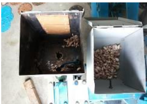
ภาพที่ 8.4-1 การเลือกงานหยอดและปลอกลูกหยอดที่มีขนาดเหมาะสมกับขนาดกสิบกระเทียมแต่ละพันธุ์ที่แตกต่างกัน
