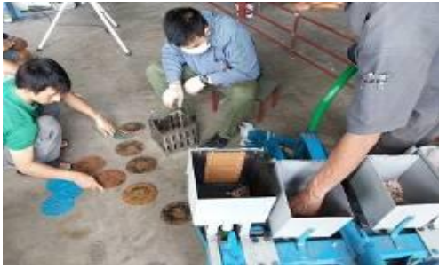
ภาพที่ 8.4-1 การเลือกงานหยอดและปลอกลูกหยอดที่มีขนาดเหมาะสมกับขนาดกสิบกระเทียมแต่ละพันธุ์ที่แตกต่างกัน
