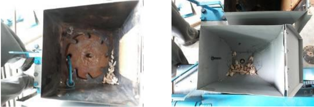
ภาพที่ 8.5-1 เปรียบเทียบลักษณะของกลไกการหยอด 2 แบบ คือแบบจานหยอดและแบบลูกหยอด
