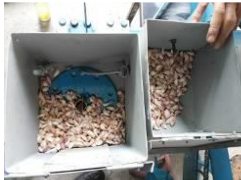
ภาพที่ 8.5-2 การทดสอบเปรียบเทียบลักษณะการทำงานของกลไกการหยอด 2 แบบ คือแบบจานหยอดและแบบลูกหยอด
