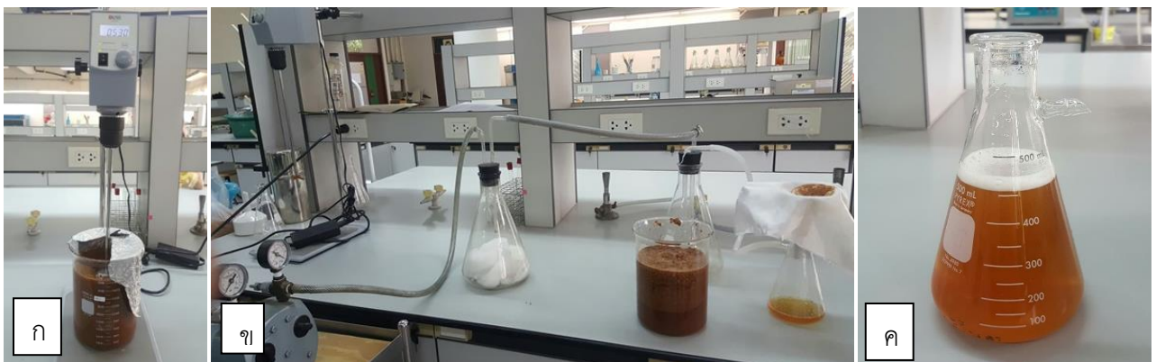
ภาพผนวกที่ 8 การปั่นสารละลายผสมระหว่างเปลือกมะพร้าวแห้งและเอทานอล (ก) กรองด้วยชุดเครื่องปั๊มสุญญากาศ (ข) และสารสกัดจากเปลือกมะพร้าวภายหลังการสกัดด้วยเอทานอลความเข้มข้นต่าง ๆ เป็นระยะเวลา 24 ชั่วโมง (ค)
