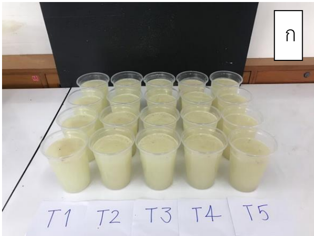
ภาพที่ 1 น้ำเสียที่เก็บตัวอย่างมาจากน้ำเสียจากโรงงานแปรรูปมะพร้าว อ.สวี จ.ชุมพร ก่อนบำบัด (ภาพ ก) และหลังการบำบัด (ภาพ ข) ด้วยจากสารสกัดแทนนินจากเปลือกมะพร้าวอ่อน
