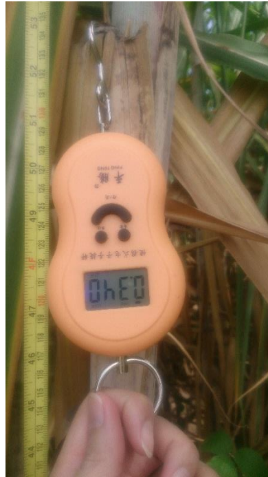
ภาพที่ 12 วัดแรงดึงใบโดยใช้เครื่องชั่งสปริงแบบแขวนดิจิทัลขนาด 15 kg
