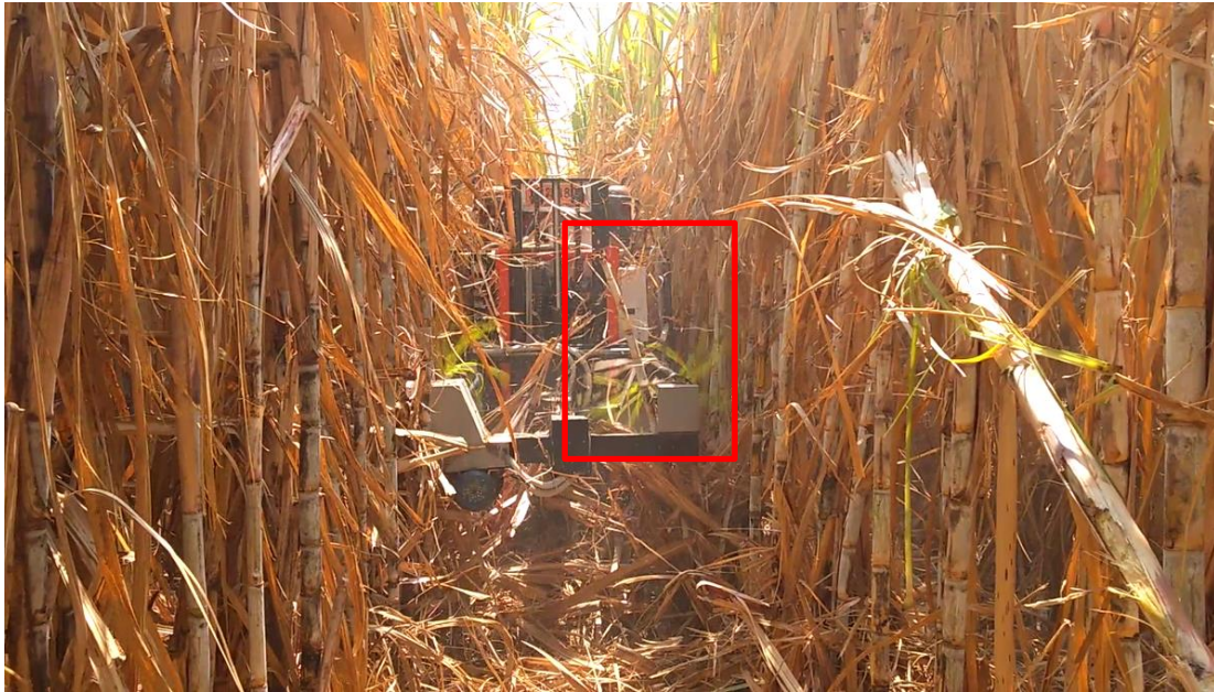
ภาพที่ 23. ความเสียหายที่ลำอ้อยจากการเคลื่อนที่ลงของลูกดีสางใบระหว่างทำการสาง
