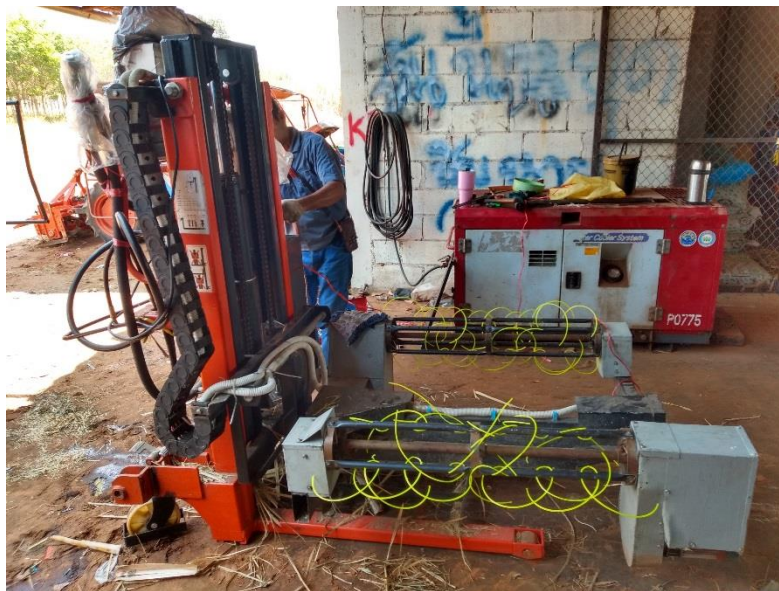
ภาพที่ 2 โครงสร้างของเครื่องแสงใบอ้อยสำหรับอ้อยตัดทำพันธุ์
