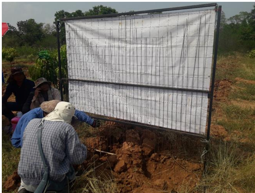
ภาพที่ 17 แสดงการวัดพื้นที่การแตกตัวของดินในส่วนที่เป็นหลุมโดยใช้ Profile meter
