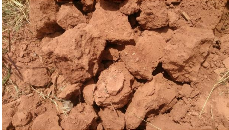
ภาพที่ 20 การแตกตัวของดินขณะขุดไม่สั่น ความลึกในการไถ 30 เซนติเมตร ความเร็วในการเคลื่อนที่ Low 2
