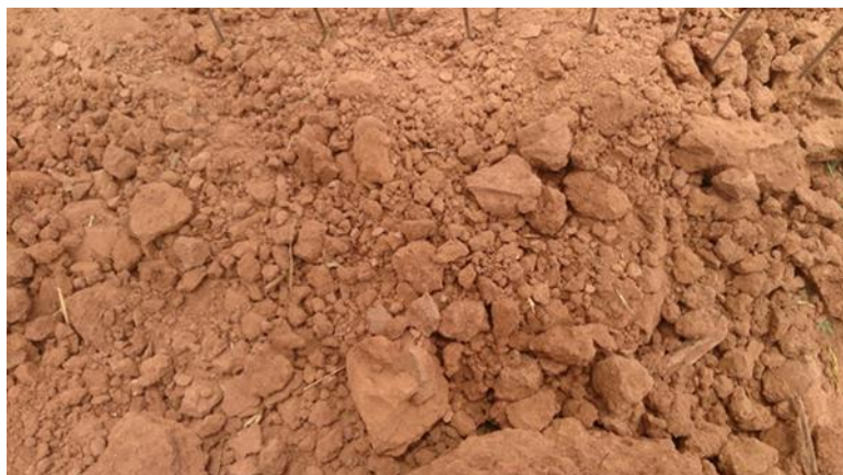
ภาพที่ 19 การแตกตัวของดินขณะขาไถสั่นที่ความถี่ 11 เฮิรตซ์ ความลึกในการไถ 30 เซนติเมตร ความเร็วในการเคลื่อนที่ Low 2
