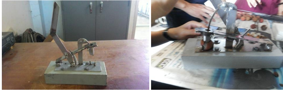
ภาพที่ 3 เครื่องคว้านเมล็ดลิ้นจี่ แบบใช้แรงคนกด
