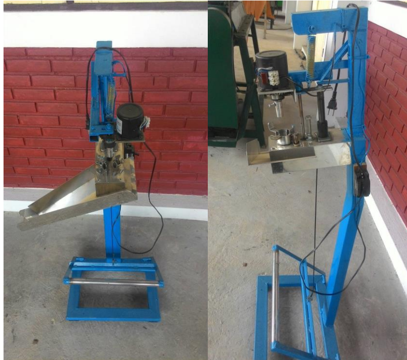
ภาพที่ 4 เครื่องคว้านเมล็ดลิ้นจี่แบบใช้มอเตอร์ไฟฟ้าเป็นต้นกำลัง
