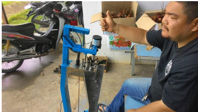
ภาพที่ 5 การทดสอบเครื่องคว้านเมล็ดลิ้นจี่แบบใช้มอเตอร์ไฟฟ้าเป็นต้นกำลัง
