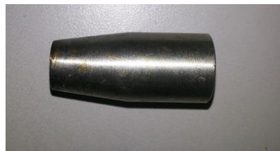
ภาพที่ 1 ลักษณะหัวคว้านของเครื่องคว้านเมล็ดลีนี่ซึ่งมีลักษณะเป็นโคน มีขนาดเส้นผ่านศูนย์กลางที่สามารถปรับให้เข้ากับลีนี่แต่ละสายพันธุ์ได้
