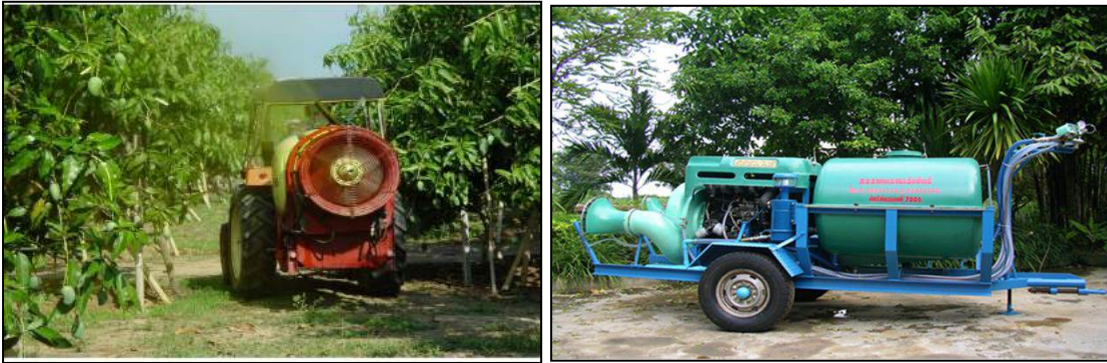
ภาพที่ 14 เครื่องยนต์พ่นสารแบบใช้แรงลมขนาดใหญ่ เครื่องยนต์พ่นสารแบบแอร์บลิสท์ (ซ้าย) และแบบแอร์เชียร์ (ขวา)
