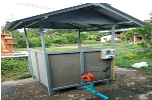
ภาพโรงปุ๋ยหมักระบบเติมอากาศ ขนาดกว้าง ๑.๑ เมตร ยาว ๑.๔ เมตร สูง ๑.๐ เมตร
