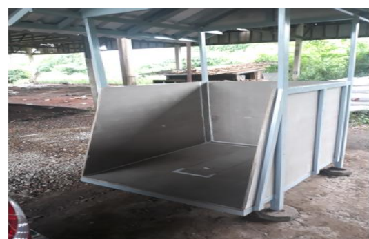
ภาพโรงปุ๋ยหมักระบบเติมอากาศ ขนาดกว้าง ๑.๑ เมตร ยาว ๑.๔ เมตร สูง ๑.๐ เมตร
