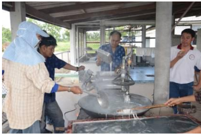
ภาพที่ 4.8 การทดสอบการโรยเส้นวุ้นเส้น
