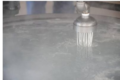
ภาพที่ 4.9 ลักษณะเส้นที่โรยออกมามีการขาดเป็นบาง ช่วง
