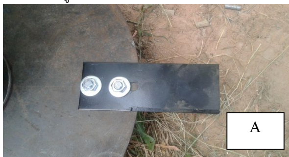
รูปที่ 4 ลักษณะไบมีดที่ใช้สำหรับการทดสอบตัดต่ออ้อย (A) ไบมีดแบบแบน (B) ไบมีดแบบวงเคียน
