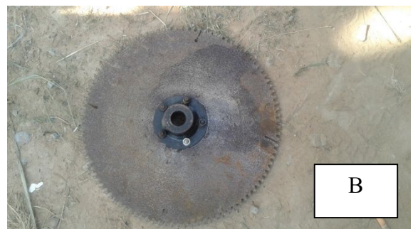
รูปที่ 4 ลักษณะไบมีดที่ใช้สำหรับการทดสอบตัดต่ออ้อย (A) ไบมีดแบบแบน (B) ไบมีดแบบวงเคียน
