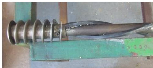
ภาพที่ 9 แกนขัดเปลือกถั่วเขียวผ่าซีกแช่น้ำแบบที่ 1
