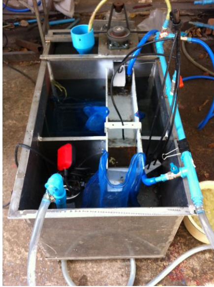
ภาพที่ 16 เครื่องล้างเปลือกถั่วเขียวซีกแช่น้ำแบบรางแนวนอน
