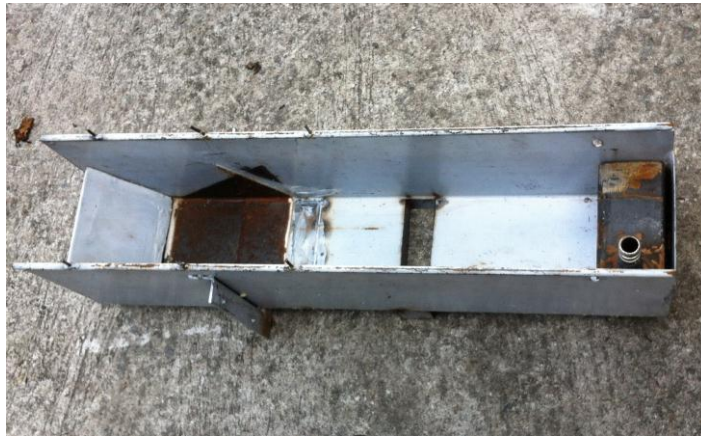
ภาพที่ 15 แสดงรางลอยเปลือกที่ใช้ในการทดสอบ
