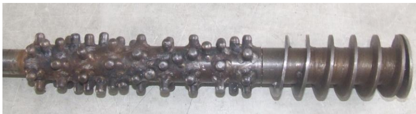
ภาพที่ 12 แกนชุดเปลือกถั่วเขียวผ่าซีกแช่น้ำแบบที่ 4
