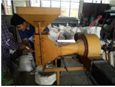
รูปที่ 5 ชุดทดสอบเพื่อศึกษาความเป็นไปได้ในการคัดแยกเศษวัสดุเจือปนออกจากมันเส้น
