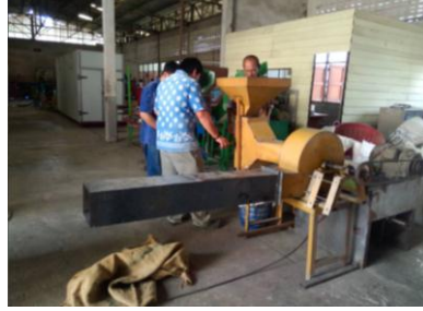
รูปที่ 5 ชุดทดสอบเพื่อศึกษาความเป็นไปได้ในการคัดแยกเศษวัสดุเจือปนออกจากมันเส้น
