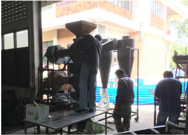
รูปที่ 9 ขณะทดสอบระบบการทำความสะอาดมันเส้นที่มีการติดตั้งไซโคลนแล้ว
