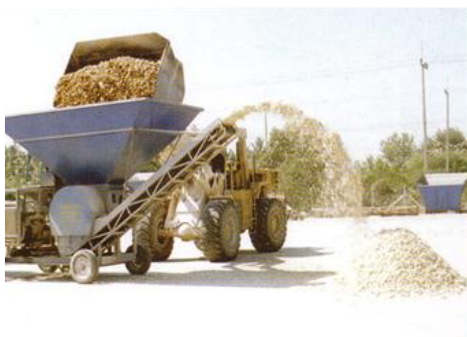
รูปที่ 2 เครื่องโม่มันเส้นขนาดใหญ่ ที่มา : ดนัย (2537)
