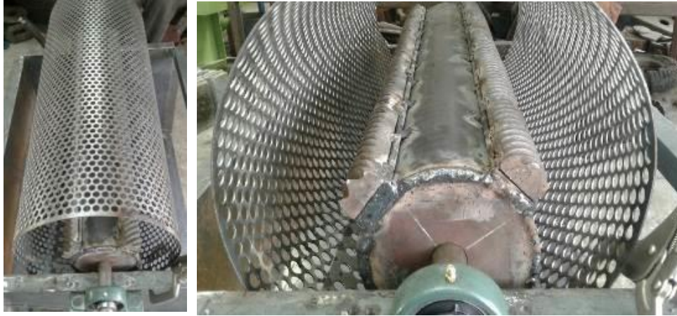
รูปที่ 2 ระบบกะเทาะแบบแถบเหล็กหล่อสำหรับกะเทาะข้าวโพด
