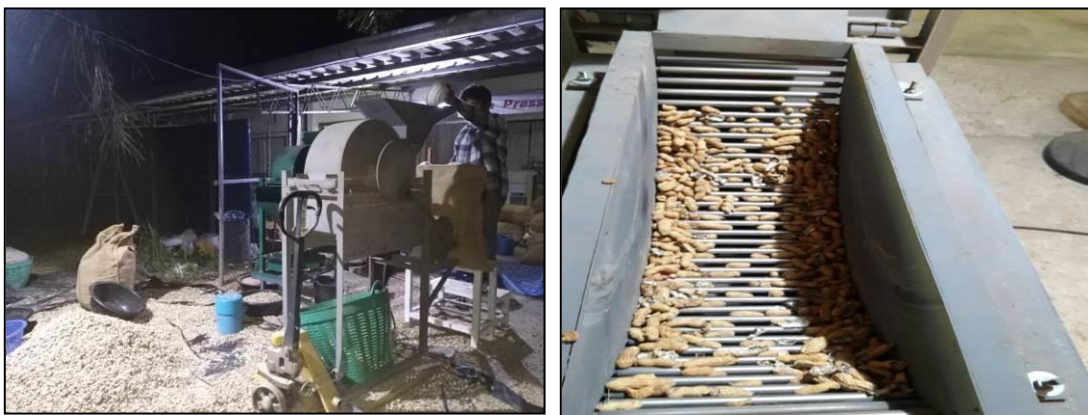
ภาพที่ 27 ตะแกรงขนาด 12 มิลลิเมตร ไม่สามารถใช้กับถั่วพันธุ์ขอนแก่น 6 ได้เนื่องจากเมล็ดมีขนาดใหญ่
