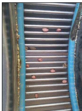
ภาพที่ 28 การปิดช่องตะแกรงเพื่อเพิ่มประสิทธิภาพการกะเทาะเนื่องจากบริเวณด้านข้างของถั่วมีลักษณะโค้งไม่สัมพันธ์เมล็ดถั่ว
