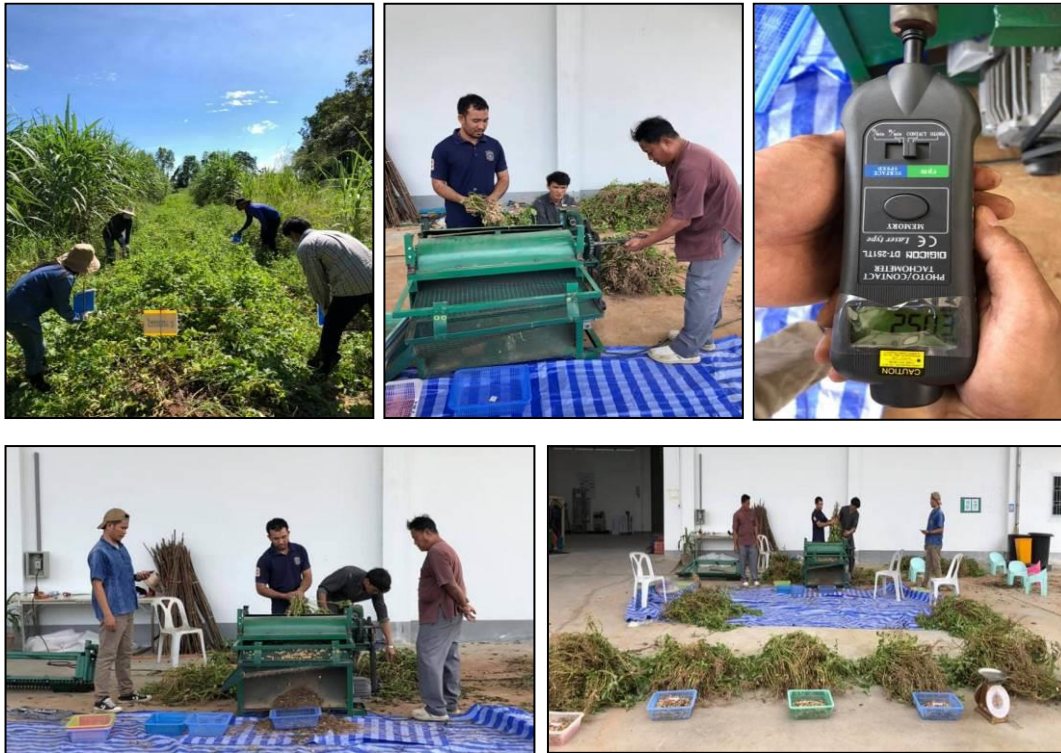
ภาพที่ 18 เก็บเกี่ยวถั่วลิสงฝักขนาดเล็ก และทดสอบการปลิดฝักถั่วลิสงด้วยเครื่องปลิดฝักตามความเร็วรอบที่กำหนดเพื่อหาความเร็วรอบที่เหมาะสม
