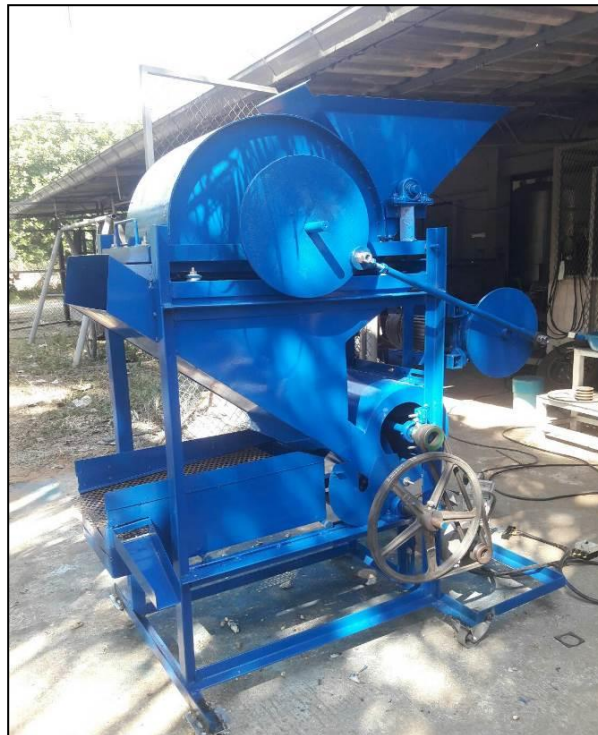
ภาพที่ 31 ต้นแบบของเครื่องกะเทาะถั่วลิสงแบบล้ออย่างที่ใช้การกะเทาะแบบหมุนไป-กลับ
