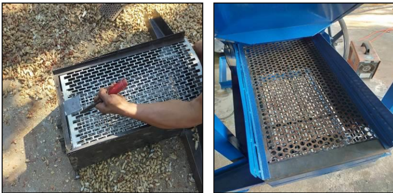
ภาพที่ 30 ลักษณะตะแกรงที่เหมาะสมต่อการทำความสะอาดซึ่งสามารถเปลี่ยนได้ตามขนาดเมล็ดพันธุ์
