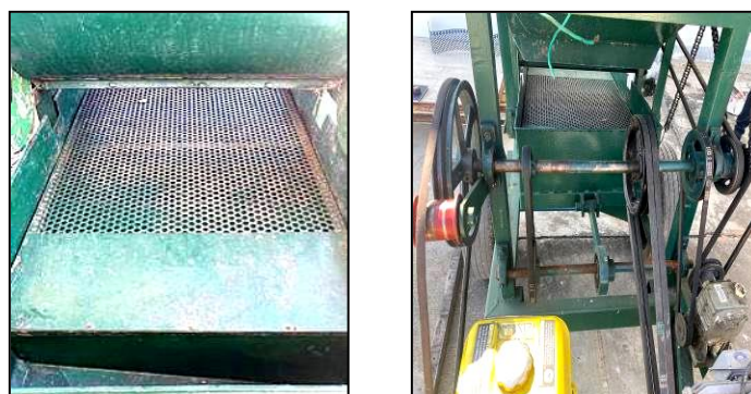
ภาพที่ 13 ตะแกรงคัดขนาดและทำความสะอาดสิ่งเจือปนหนัก
