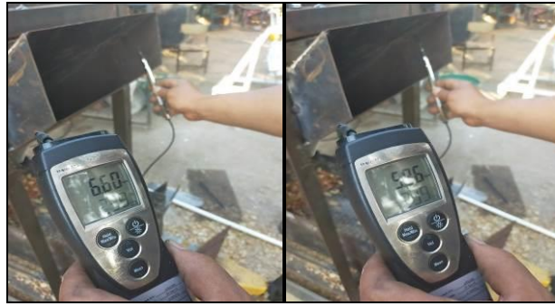
ภาพที่ 29 ทดสอบความเร็วลมที่เหมาะสมต่อการทำความสะอาด
