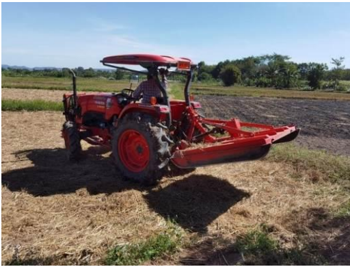
การเตรียมแปลงด้วยการใช้รถตัดตอซังข้าวและแปลงทุถูกเผาตอซังข้าว
