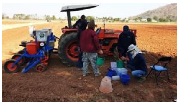
ภาพที่ 20 การวัดและชั่งน้ำหนักปุ๋ยเพื่อหาอัตราการหยอดปุ๋ยในภาคสนาม
