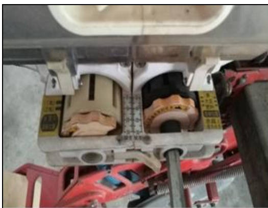
ภาพที่ 4 สกรูปรับขนาดล้อรองของรูลอยดเมล็ด (ซ้าย) และสกรูปรับขนาดล้อรองของรูลอยดปุ๋ย (ขวา)
