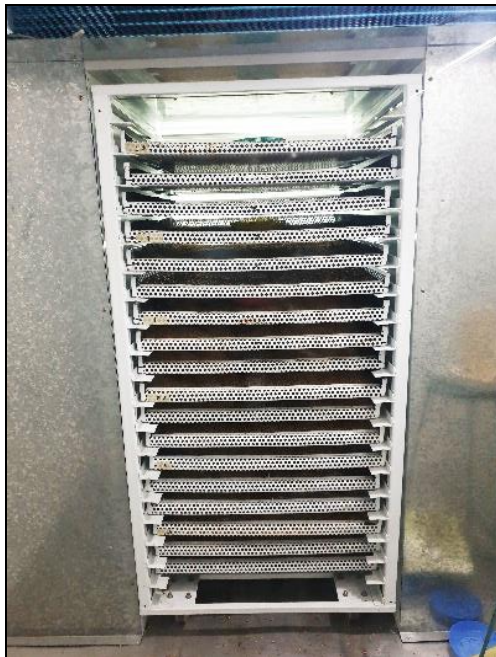
ภาพผนวกที่ 2 ตำแหน่งตัวอย่างเมล็ดพันธุ์ถั่วเหลืองสำหรับการตรวจสอบความชื้น ในเครื่องอบลดความชื้นแบบ ป้อนความร้อน ณ สถาบันวิจัยเกษตรวิศวกรรม กรมวิชาการเกษตร กรุงเทพฯ
