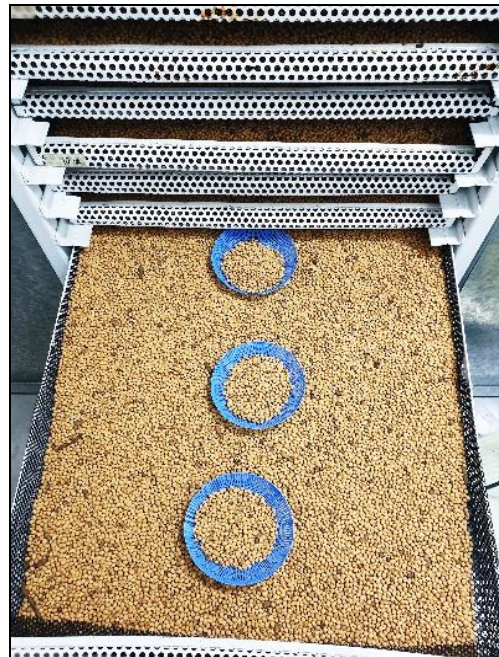
ภาพผนวกที่ 2 ตำแหน่งตัวอย่างเมล็ดพันธุ์ถั่วเหลืองสำหรับการตรวจสอบความชื้น ในเครื่องอบลดความชื้นแบบ ป้อนความร้อน ณ สถาบันวิจัยเกษตรวิศวกรรม กรมวิชาการเกษตร กรุงเทพฯ
