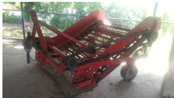
ภาพที่ 43 เครื่องซุดถั่วลิสงแบบมีซุดลำเลียงต้นถั่วแล้วตากไว้ในแปลง ของโรงงานท้องถิ่น
