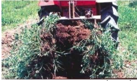
ภาพที่ 15 แสดงลักษณะการทำงานของเครื่องขุดถั่วลิสงเมล็ดโต ที่มา: วินิต (2545)
