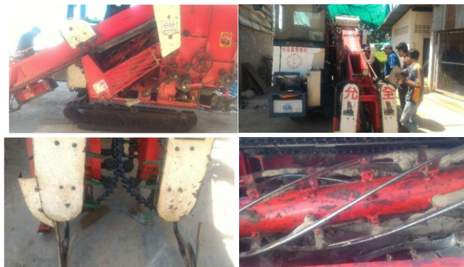
ภาพที่ 41 ใบซุด และโซ่หนีบต้นถั่ว และซุดปลิดฝัก ของเครื่องซุดถั่วลิสงจากไต้หวัน
