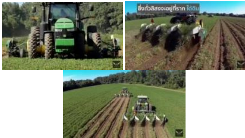
ภาพที่ 18 เครื่องขุดถั่วลิสงขนาดใหญ่ขุดเขย่า และโรยตากแบบพลิกกลับของต่างประเทศ
