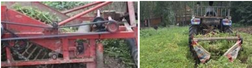
ภาพที่ 13 เครื่องซุดถั่วลิสงขนาดกลางของประเทศจีนแบบซึดติดกับชาซุดและมีซุดลำเลียงต้นถั่ว
