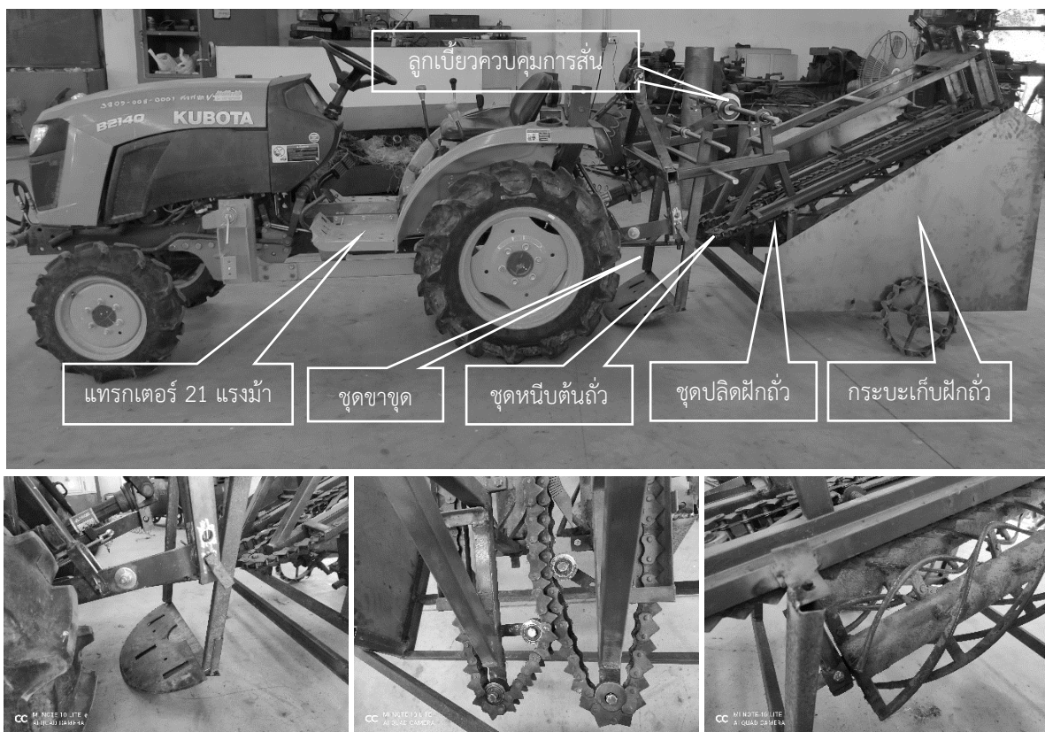
ภาพที่ 48 ต้นแบบแรก เครื่องชุดเก็บและปลิดฝักถั่วลิสง ที่ควบคุมการสั่นของขาชุดด้วยระบบอัตโนมัติ แบบติดตั้ง ท้ายรถแทรกเตอร์ขนาดเล็ก เพื่อการผลิตเมล็ดพันธุ์
