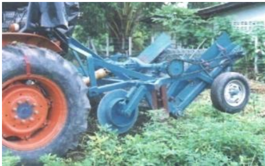
ภาพที่ 16 เครื่องเก็บเกี่ยวถั่วลิสงพวงท้ายรถแทรกเตอร์ แบบใบมีดขุด แยกดินและโรยตาก ที่มา: ไชยรงค์ ( 2543)
