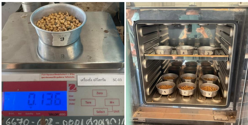
ภาพที่ 2.4 การหาความชื้นเริ่มต้น-สุดท้าย ของเมล็ดพันธุ์ถั่วเหลืองโดยตู้อบลมร้อน
