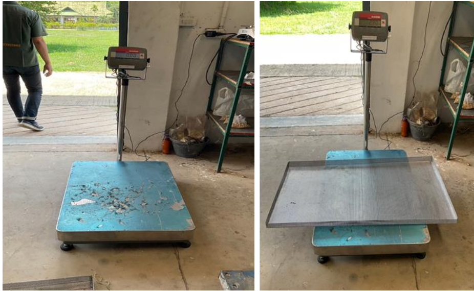
ภาพผนวก ค ที่ 3 เครื่องชั่งน้ำหนักระบบอิเล็กทรอนิกส์ พิกัดโหลด 300 กิโลกรัม
