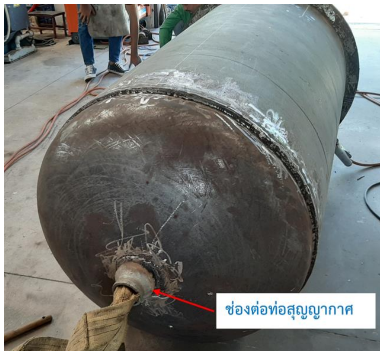
ภาพผนวก ข ที่ 2 ถังอบสุญญากาศด้านตรงข้ามกับช่องมองผลิตภัณฑ์เป็นท่อต่อเข้ากับระบบปั๊มสุญญากาศ
