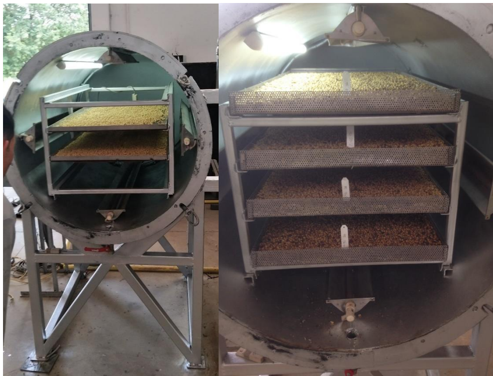
ภาพที่ 2.2 การบรรจุเมล็ดถั่วเหลืองในถาดวางของเครื่องอบแห้งลดแรงดันอากาศ
