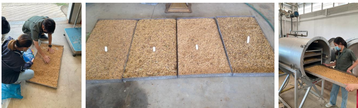
ภาพผนวก ค ที่ 5 การเตรียมเมล็ดพันธุ์ถั่วเหลืองใส่ภาตตะแกรงและนำเข้าเครื่องอบลดแรงดันอากาศ
