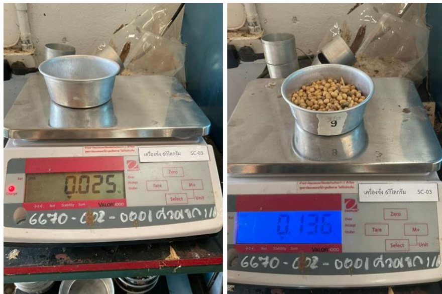
ภาพผนวก ค ที่ 2 เครื่องชั่งน้ำหนักระบบอิเล็กทรอนิกส์ พิกัดโหลด 6 กิโลกรัม
