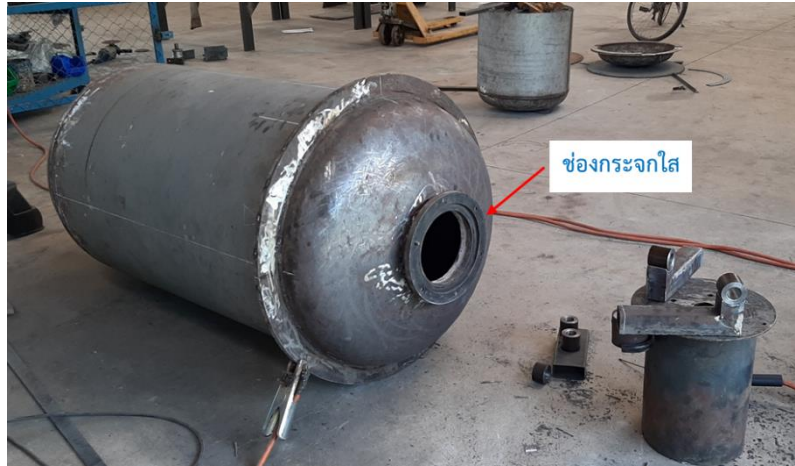
ภาพผนวก ข ที่ 1 ถังอบแห้งสุญญากาศทรงกระบอก มีช่องมองผลิตภัณฑ์เป็นช่องกระจกใส
