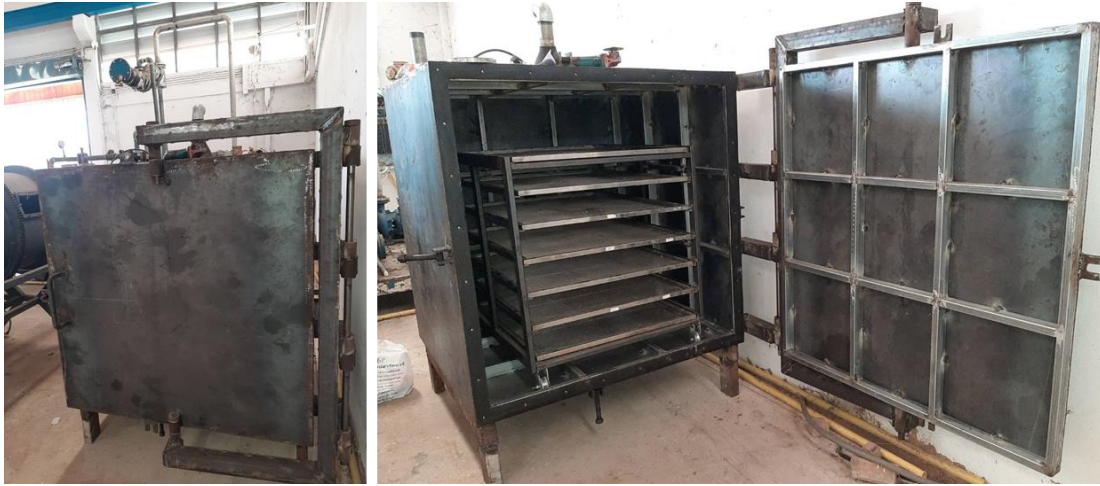
ภาพที่ 1.25 ห้องอบแห้งลดแรงดันอากาศ ทรงสี่เหลี่ยม ขนาด กว้าง x ยาว x สูง 1.20 x 1.20 x 1.20 เมตร
