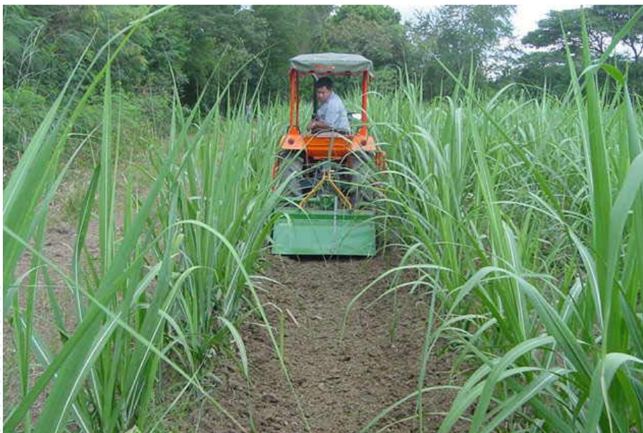
รูปที่ 11 จอบหมุนขนาด 80 เซนติเมตรที่พัฒนาขึ้นเพื่อให้สามารถเข้าไปพรวนดินกำจัดวัชพืชในร่องอ้อย
