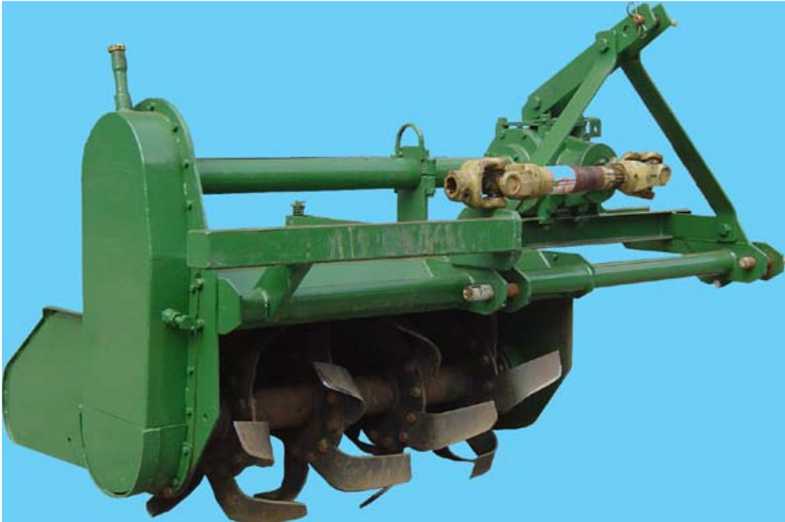
รูปที่ 20 แสดงจอบหมุนสับใบอ้อยแบบแถวเดี่ยวซึ่งเอกชนผลิตจำหน่าย
