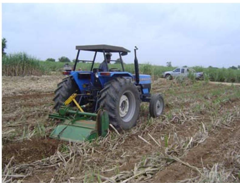
รูปที่ 19 แสดงการทำงานของจอบหมุนพรวนดินและสับใบอ้อย
