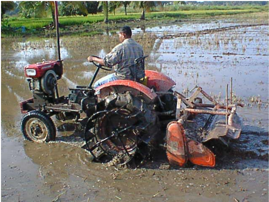
รูปที่ 3 แสดงจอบหมุนเก่าจากประเทศญี่ปุ่นซึ่งสถาบันวิจัยเกษตรวิศวกรรม ได้นำมาทดสอบ
