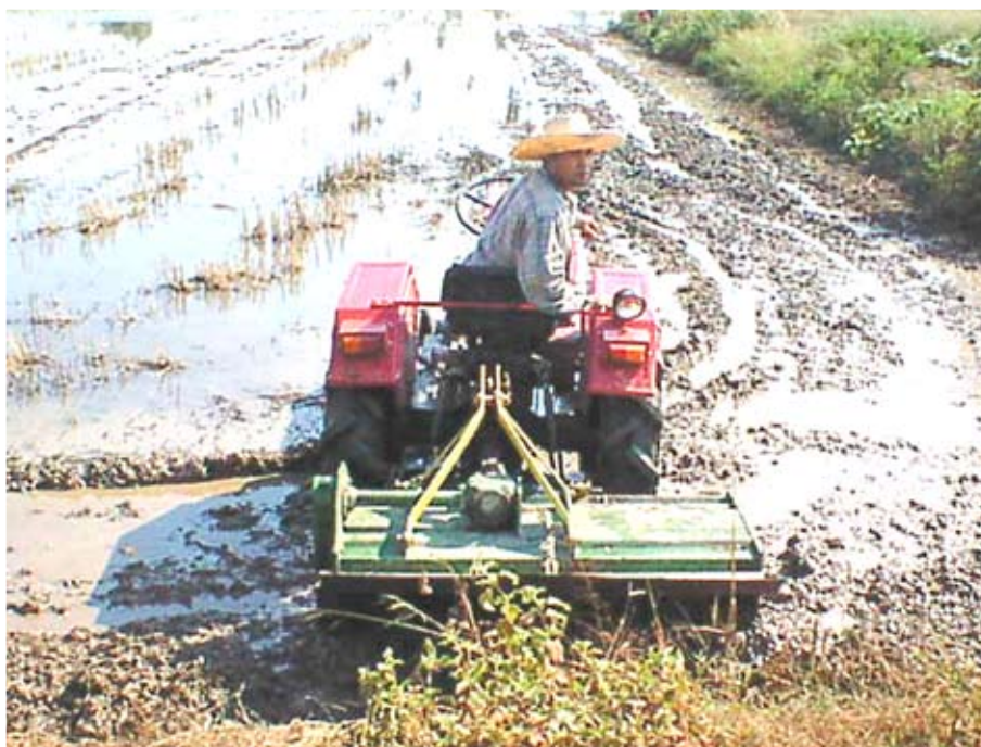
รูปที่ 6 แสดงชุดจอบหมุนที่สร้างขึ้น โดยมีจุดเด่นที่ ออกแบบให้เอียงไปทางด้านขวา
