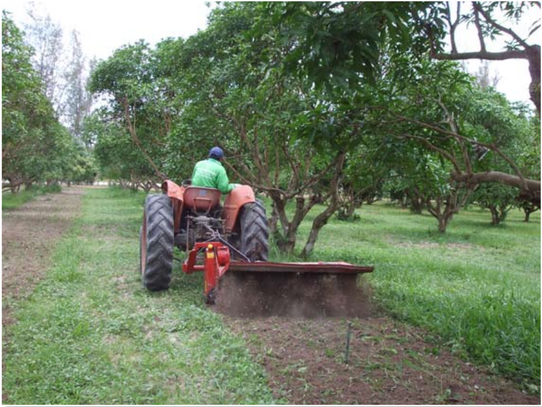
รูปที่ 14 แสดงการทำงานของจอบหมุน
