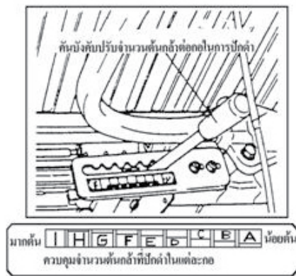
รูปที่ 26 อุปกรณ์ปรับระยะห่างระหว่างกอในแถวเดียวกัน รูปที่ 27 อุปกรณ์ควบคุมอัตราการป้อนกล้า
