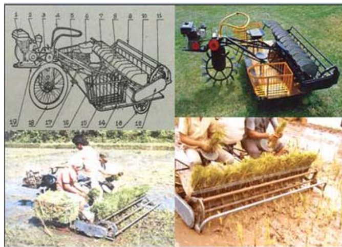
รูปที่ 10 เครื่องดำนนั่งขับ 12 แกว ใช้กล้างรากรุ่น Tong – Feng - 2A จากสาธารณรัฐประชาชนจีน
