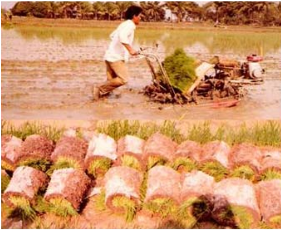
รูปที่ 11 เครื่องดำนแบบใช้กล้าแผ่น (Mat Type) จากประเทศญี่ปุ่นระยะเริ่มต้นนำเข้ามาเผยแพร่
