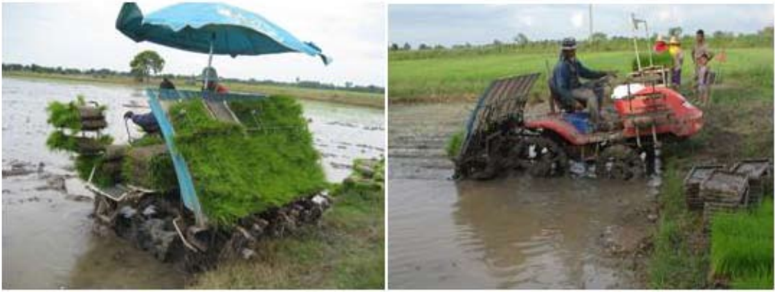
รูปที่ 36 เครื่องดำนาแบบนั่งขับขนาด 6 แกว แบบญี่ปุ่น ที่ผลิตในสาธารณรัฐประชาชนจีน
