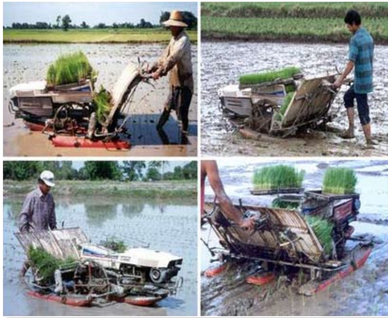
รูปที่ 14 เครื่องดำนาแบบเดินตาม 4 แกว ใช้กล้ำแผ่น Yanmar รุ่น YP - 400 จากประเทศญี่ปุ่น
