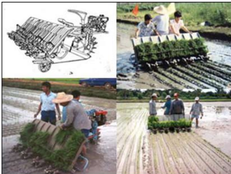
รูปที่ 13 เครื่องดำนานาแบบนั่งขับ 8 แถว ใช้กล้าแผ่น รุ่น 2-ZT-78 จากสาธารณรัฐประชาชนจีน
