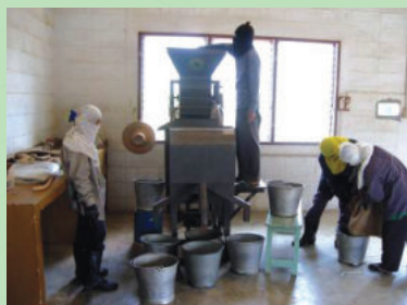
การคัสด์เมล็ดถั่วเขียว โดยใช้เครื่องแบบใช้ตะแกรงและแรงลม
