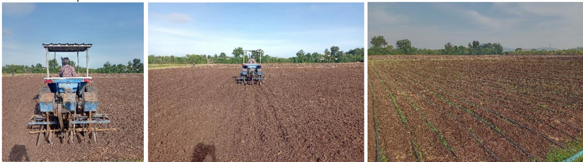
ภาพที่ 16 การปลูกข้าวฟ่างแบบหยอดเป็นหลุมในแถว โดยใช้เครื่องปลูกติดท้ายรถแทรกเตอร์
